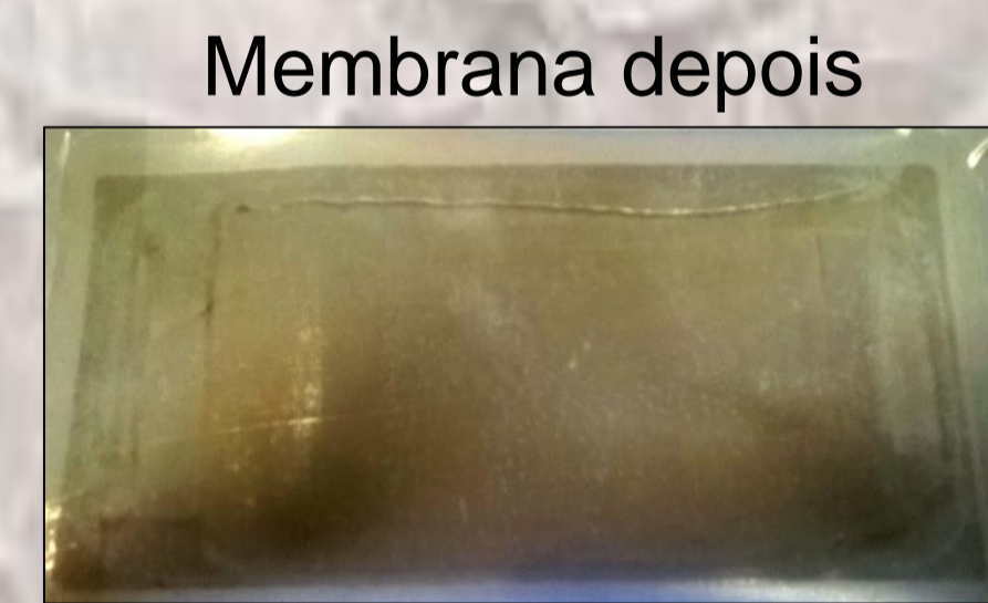
Incrustação em membrana. A avaliação do fluxo crítico permite minimizar este efeito.
