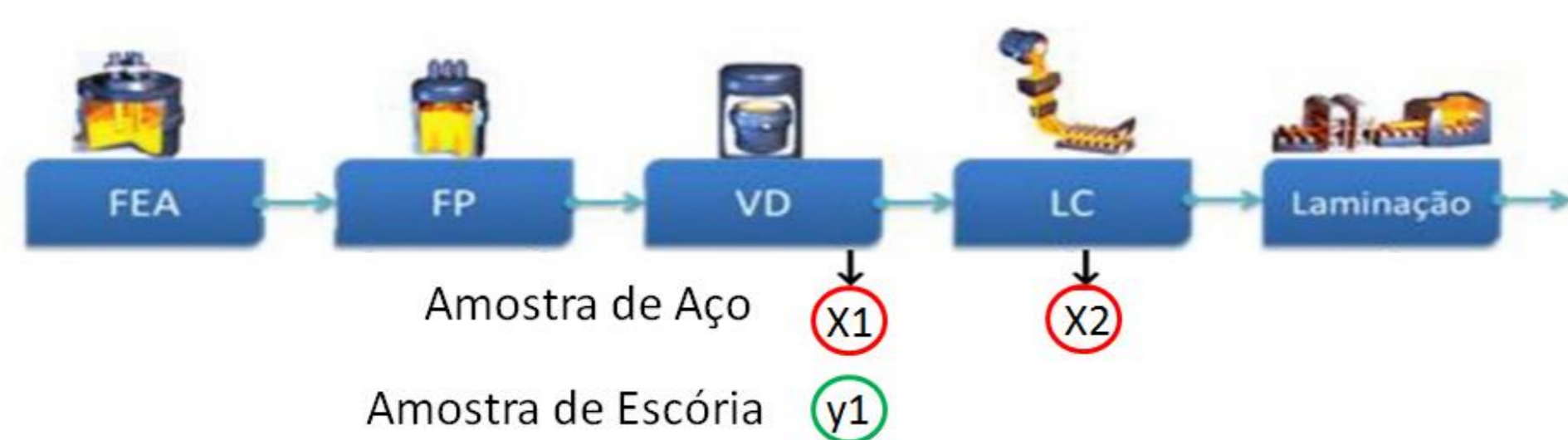
Figura 1: Fluxograma esquemático da retirada das amostras de aço e de escória.
