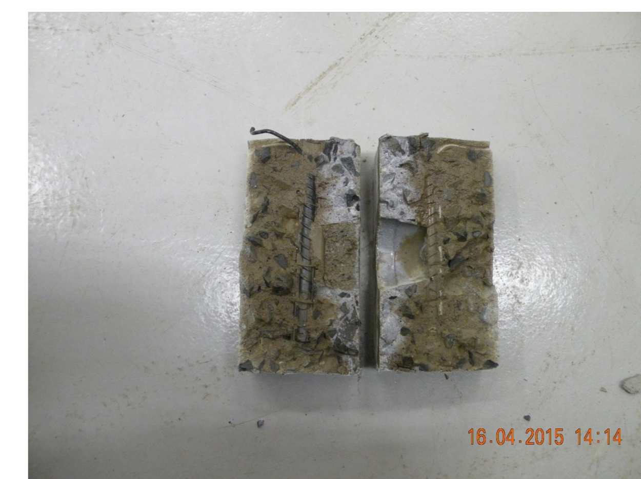
Corpo de prova com espaçador de concreto curado em câmara úmida
