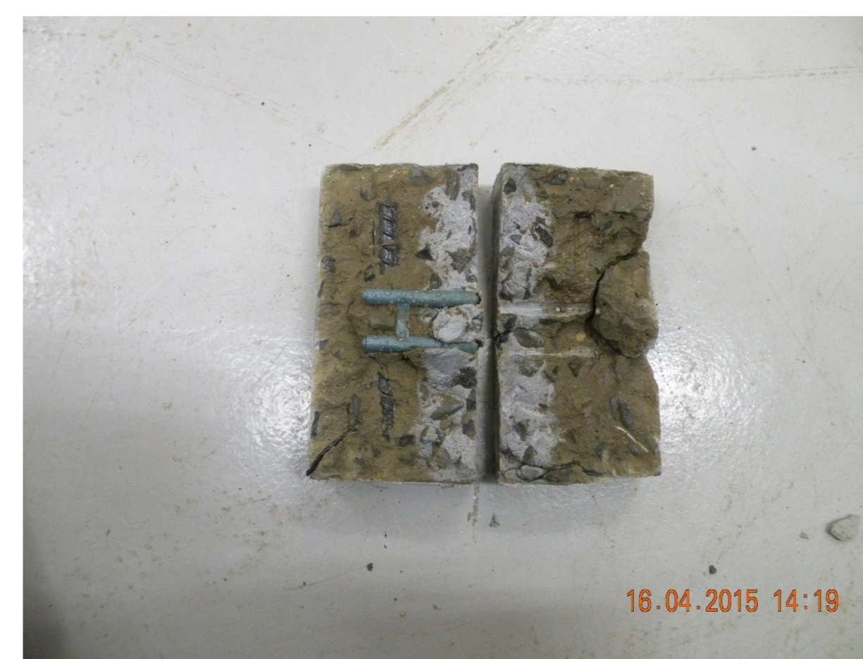
Corpo de prova com espaçador de plástico curado em câmara úmida
