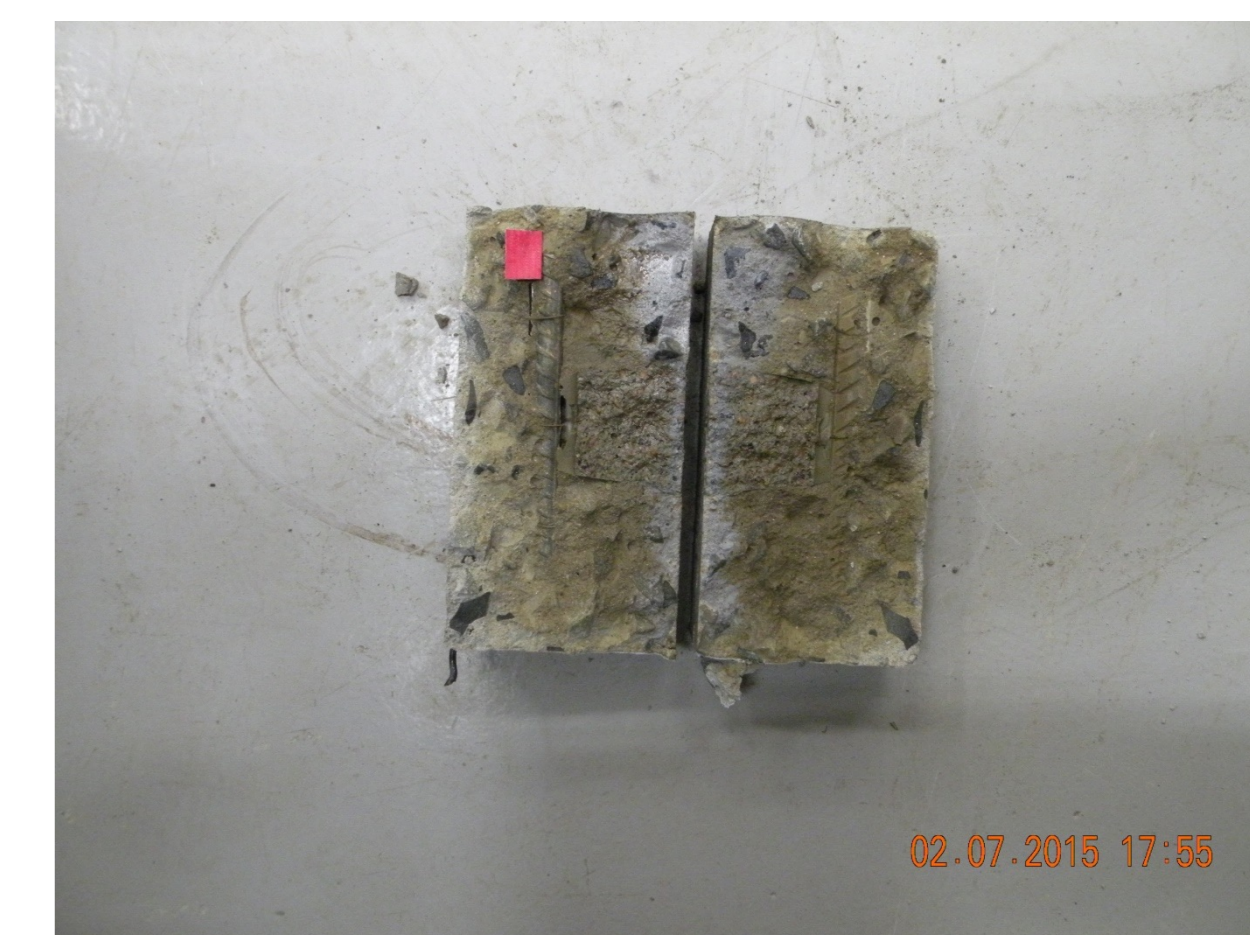
Corpo de prova com espaçador de plástico curado com ciclos de variação de temperatura
