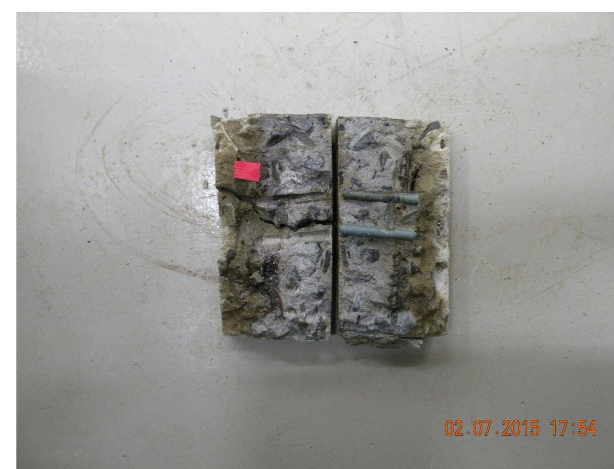
Corpo de prova com espaçador de plástico curado com ciclos de variação de temperatura
