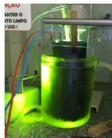
Fig.2: Equipamento de fotoeletrooxidação
