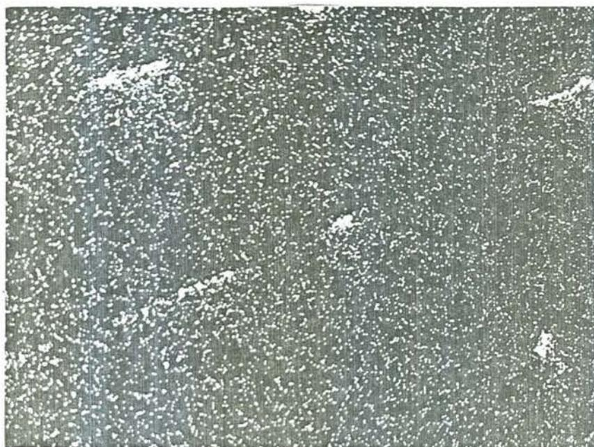
Fig. 28.5.B - Imagem de RAIÓ X do ferro correspondente à imagem eletrônica da fig. 28.5.A, 1000 X
