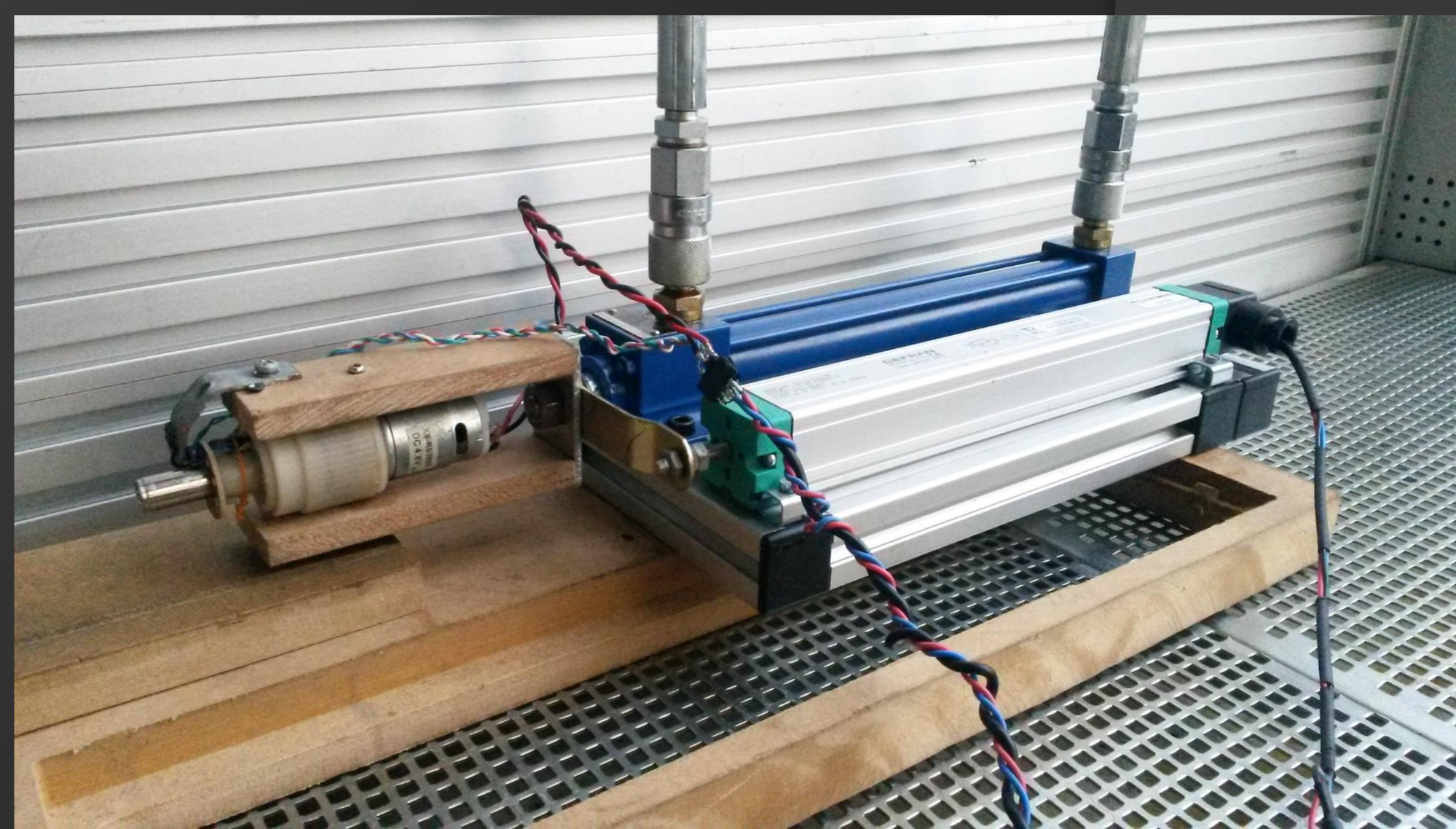
Figura 4 – Parafusadeira fixada ao atuador hidráulico.
