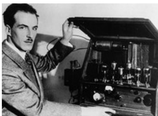
Figura 10: Theremin mostrando o interior do seu instrumento 135
