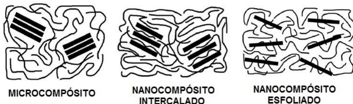
Figura 3.8 Morfologias de nanocompósitos polímero/argila (adaptado de AZEEZ et al., 2013).
