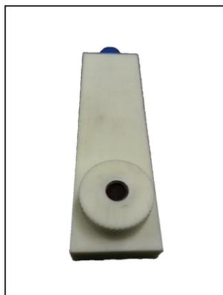
**Figura 13.** Imagem do suporte com o eletrodo de trabalho utilizado nas caracterizações eletroquímicas.
