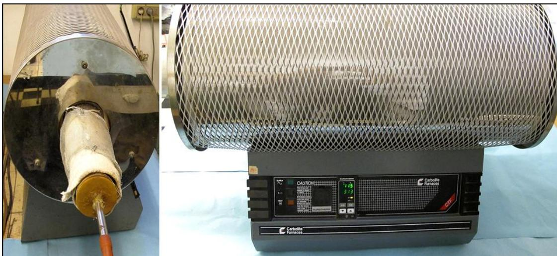
**Figura 5.** Imagem do forno tubular de laboratório utilizado para as diferentes ativações.
