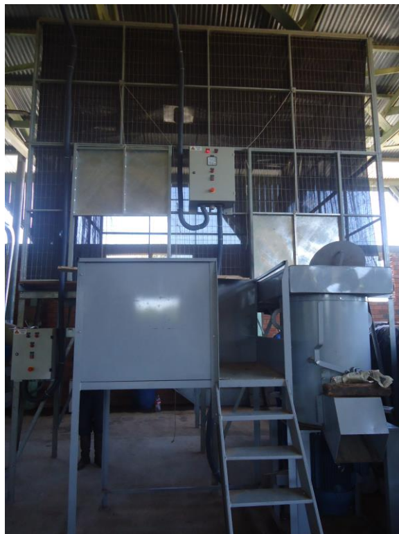
Figura 42: Aglutinador e gaiola para fim do processo para plásticos flexíveis. Fonte: Arquivo digital CAMP.
