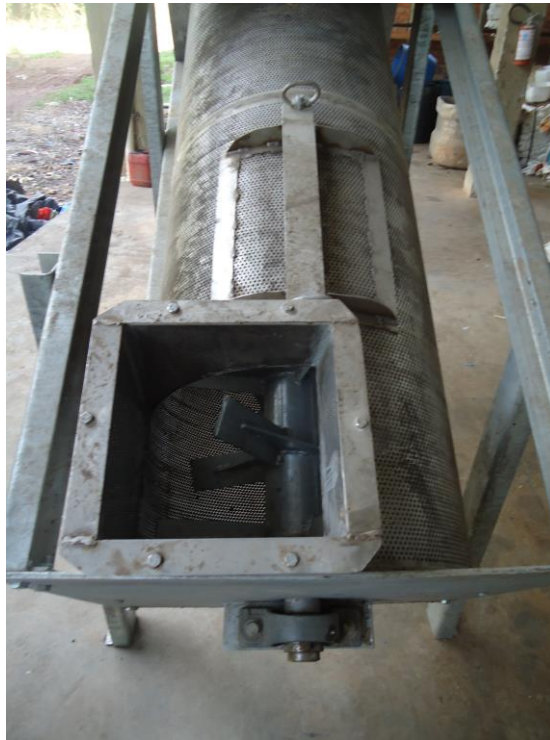
Figura 22: Detalhes de cilindro e pás de rotação e chapa perfurada de um secador inclinado. Fonte: Arquivo digital CAMP
