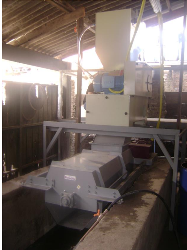
Figura 19: Moinho e Agitador. Fonte: Arquivo digital CAMP.
