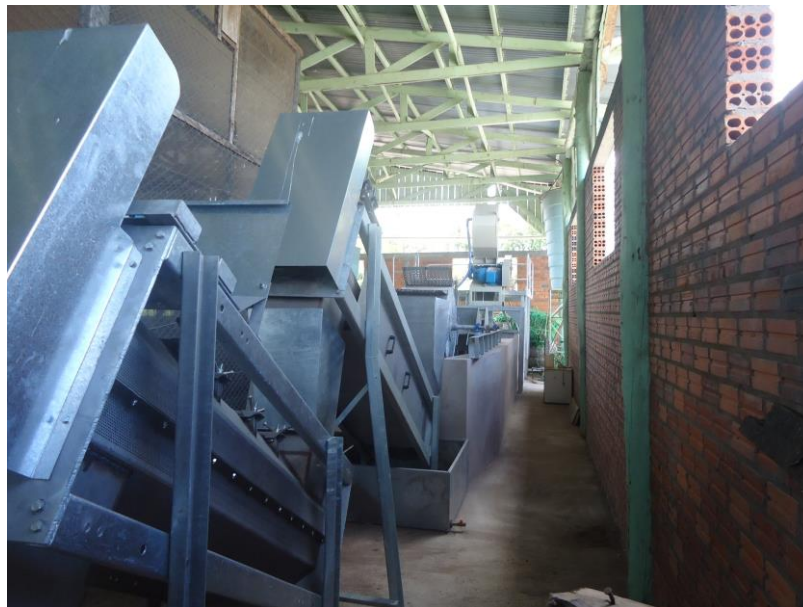
Figura 40: Secadores inclinados adequados para o processo. Fonte: Arquivo digital CAMP.
