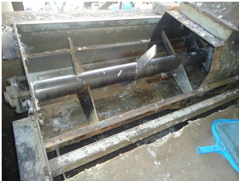
Figura 20: Cilindro e pás do agitador. Fonte: Arquivo digital CAMP
