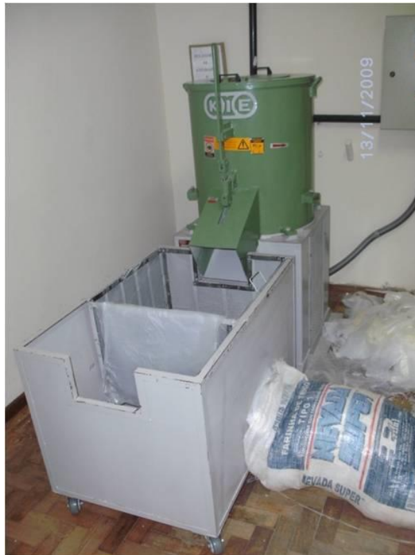
Figura 24: Equipamento aglutinador do Instituto Federal – Campus Sapucaia do Sul. Fonte: Arquivo digital CAMP
