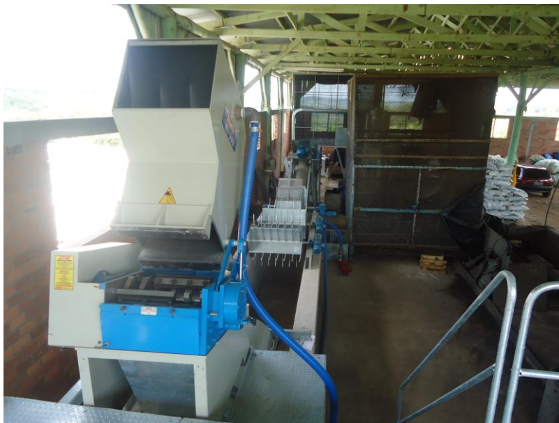
Figura 38: Moinho MF 500 de início do processo. Fonte: Arquivo digital CAMP.
