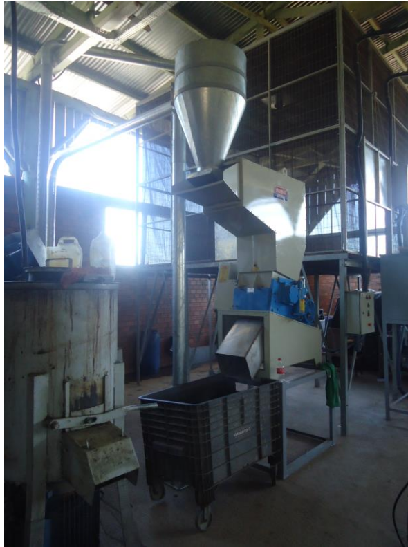
Figura 41: Moinho MF 400 para fim do processo de moagem de rígidos. Fonte: Arquivo digital CAMP.
