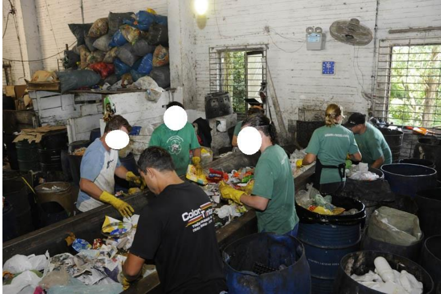
Figura 1: Processo de triagem de resíduos em esteira na Cooperativa de Dois Irmãos Fonte: Arquivo digital CAMP
