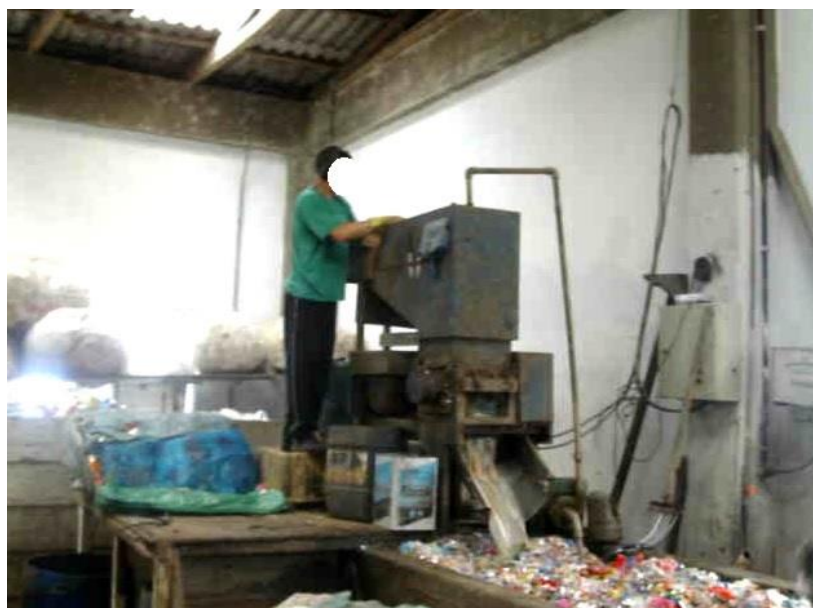
Figura 45: Moinho do início do processo. Fonte: Arquivo digital CAMP.
