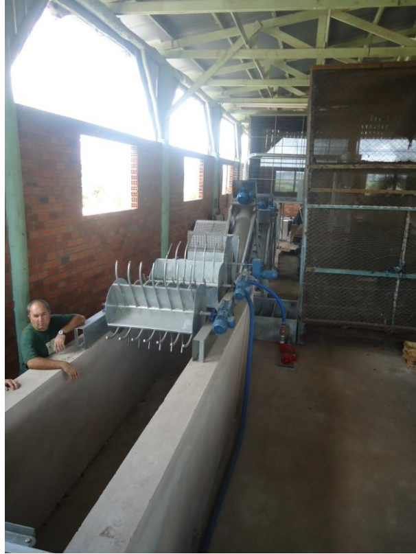
Figura 39: Tanque de alvenaria para lavagem dos resíduos plásticos e sistemas de arraste aranha Fonte: Arquivo digital CAMP
