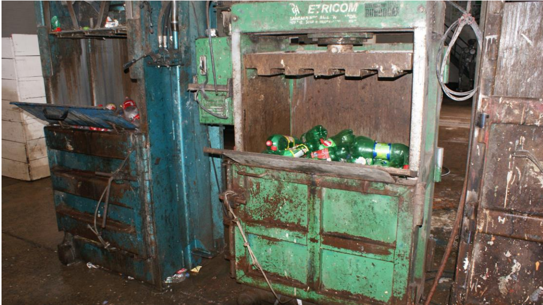
Figura 2: Processo de prensagem de materiais na Cooperativa de Dois Irmãos.
