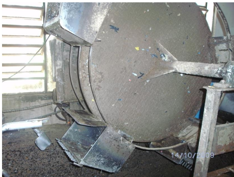
Figura 47: Roda de retirada de materiais do tanque de lavagem. Fonte: Arquivo digital CAMP.
