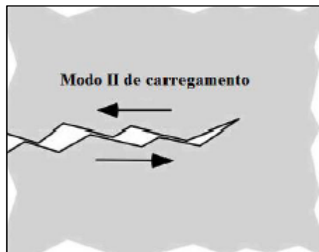
Figura 2.9: Mecanismo de fechamento induzido por rugosidade.
