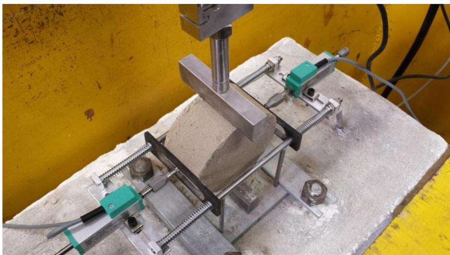
Figura 3.20: Detalhe no suporte dos medidores de distancia linear
