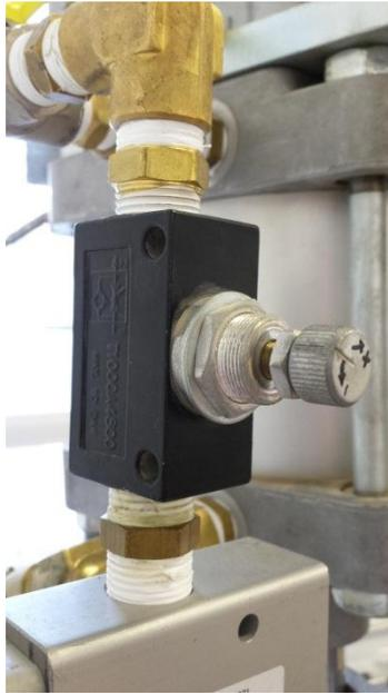
Figura 3.10: Válvula de controle de fluxo.
