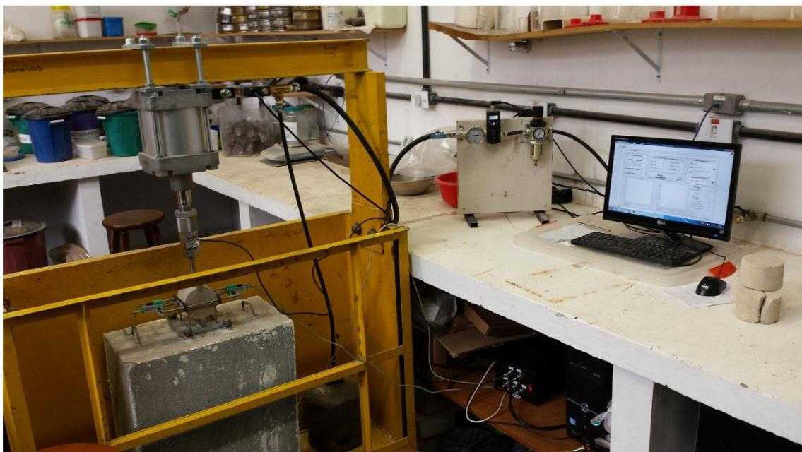
Figura 3.19: Equipamento para ensaio de vida de fadiga.
