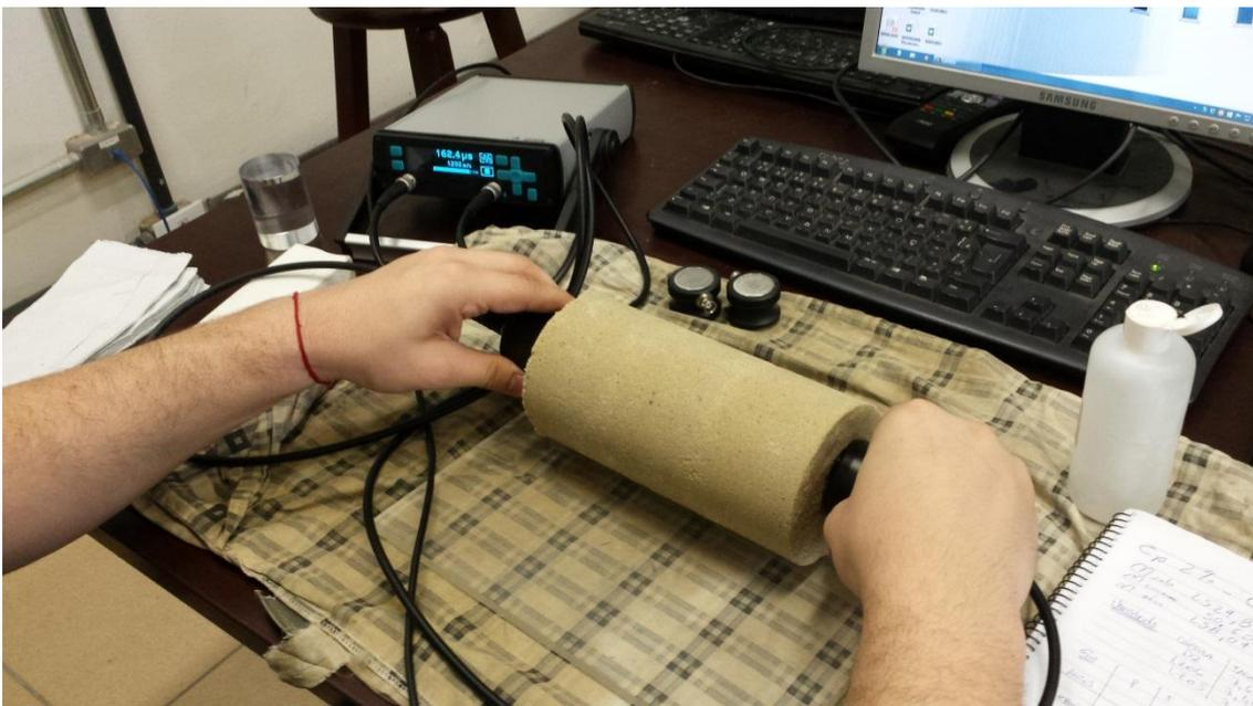
Figura 3.7: Medindo a onda p.
