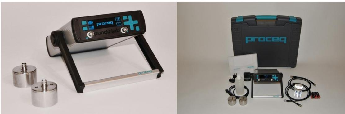
Figura 3.5: Equipamento pundit (Proceq, 2009).
