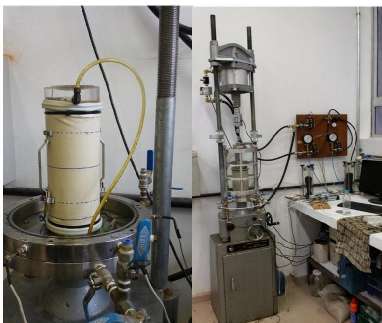
Figura 3.14: (a) amostra instrumentada (b) equipamento montado pronto para início do ensaio
