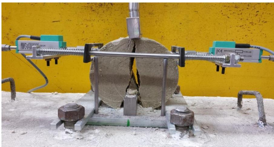
Figura 3.21: Ruptura típica por tração no ensaio de fadiga
