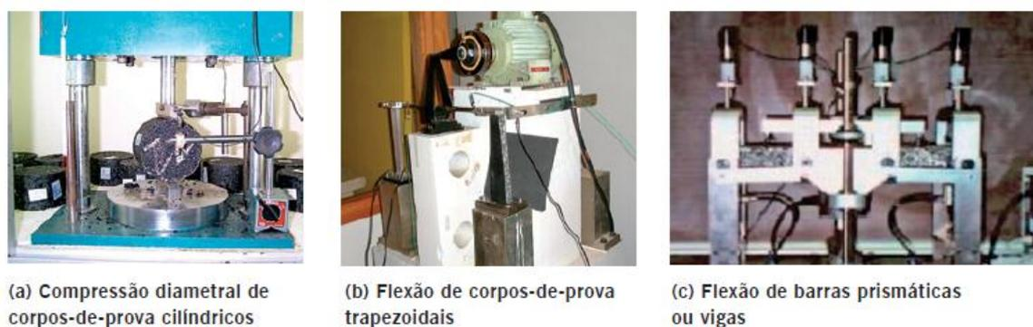
Figura 2.17: Exemplos de equipamento para ensaios de fadiga. (Adaptado de Medina (2005).
