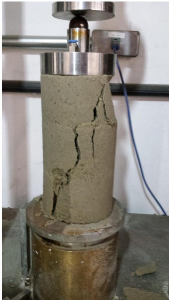
Figura 3.16: Ruptura típica a compressão simples.
