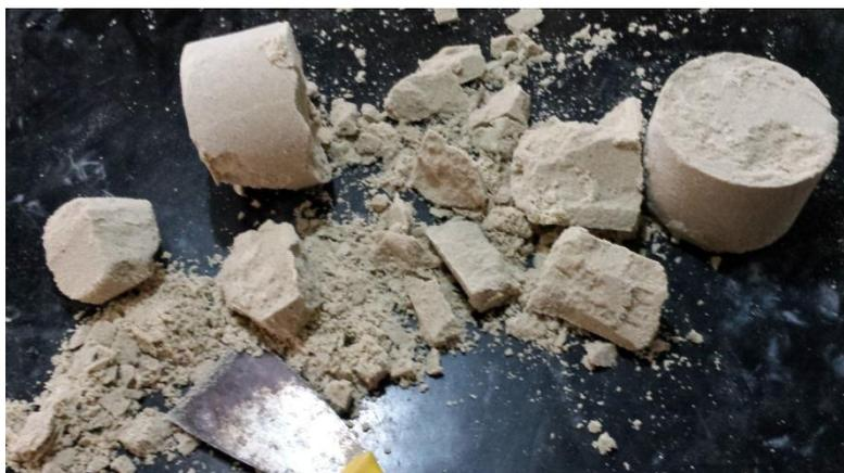
Figura 3.17: Corpo de prova desmontado para retirada da amostra de sucção e umidade após os ensaios.
