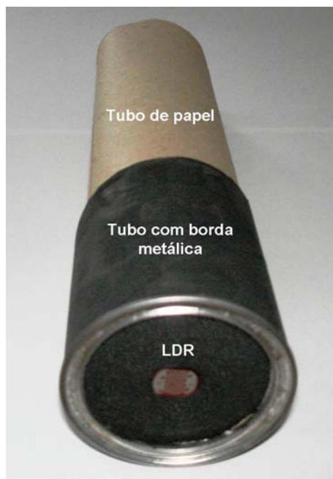
**Figura 3.11** - Encaixe do tubo com sensor no tubo com borda metálica.
