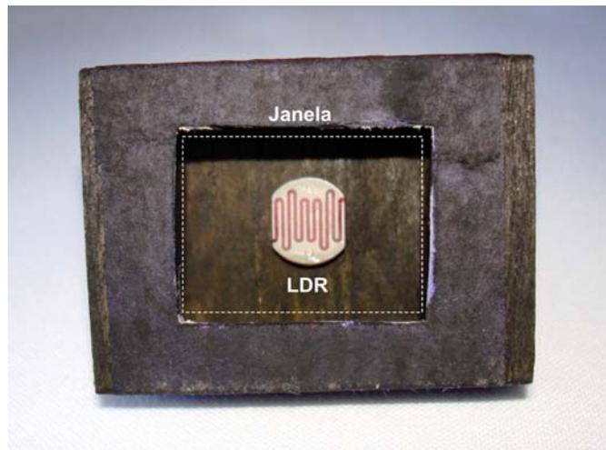
Fig. 7 - Caixa de fósforos com janela e LDR.
