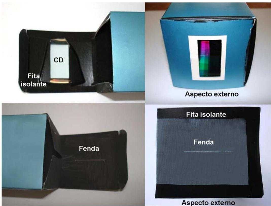
**Figura 1.9** - Montagem do espectroscópio. A) Vista interna da caixa com o fragmento do CD preso com fita isolante sobre a “janela” que existe nessa extremidade. B) Aspecto externo da caixa com o fragmento de CD posicionado na “janela”. C) Vista interna da extremidade da caixa mostrando a posição da fenda. D) Aspecto externo da caixa com as bordas vedadas com fita isolante.
