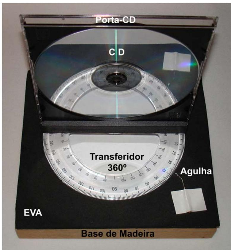
**Figura 1.17** - Montagem da grade de difração (CD) sobre a base com sistema de controle de ângulos.
