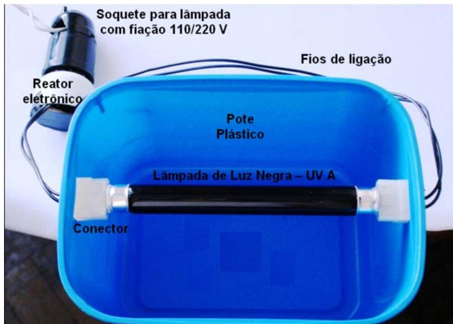
**Figura 4.2** - Disposição dos componentes da caixa de exposição. Os conectores servem como soquete para a lâmpada fluorescente.
