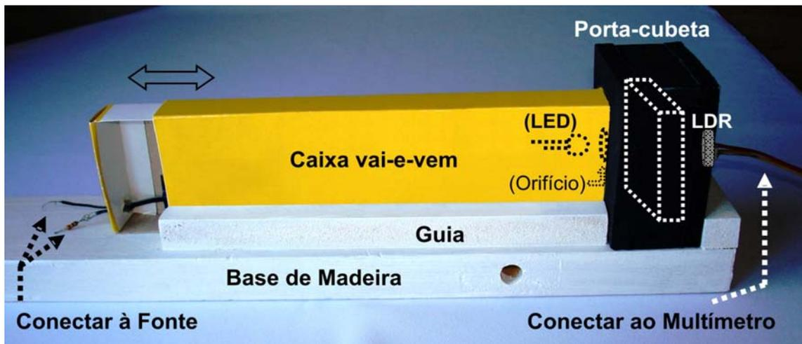
**Figura 1.13** - Espectrofotômetro com controle de intensidade luminosa pela distância da fonte luminosa a amostra.
