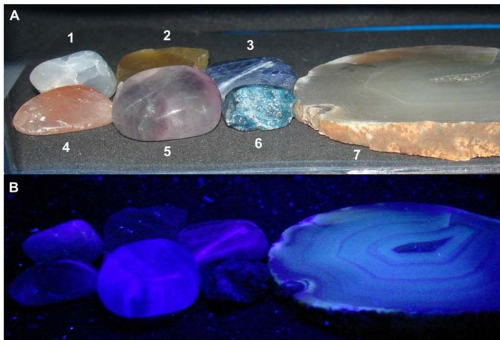
**Figura 4.7** - Amostras de minerais colocadas na câmara UV: 1 e 4) Variedades de calcita. 2 e 5) Variedades de fluorita. 3 e 6) Variedades de apatita. 7) Variedade de ágata. A) Sob iluminação de fluorescente branca. B) Sob radiação UV A.
