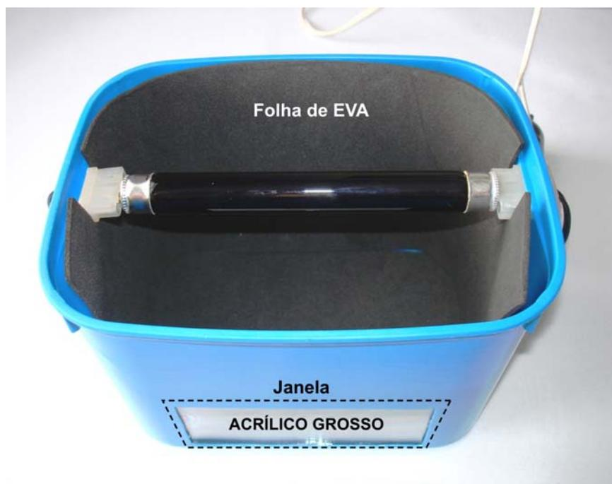
**Figura 4.3** - Montagem da câmara de exposição revestida com EVA e com janela de acrílico.
