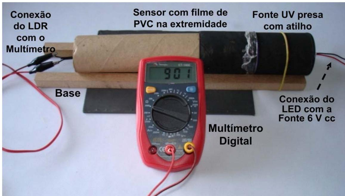
**Figura 3.17** – Visualização da montagem do sistema de aquisição de dados e da fonte com LED UV.
