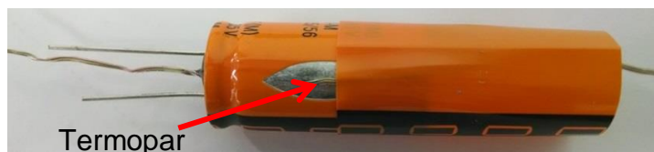
Figura 17 - Termopar colocado na caneca do capacitor
