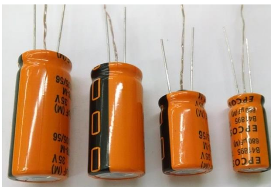
Figura 16 - Capacitores com termopar no núcleo
