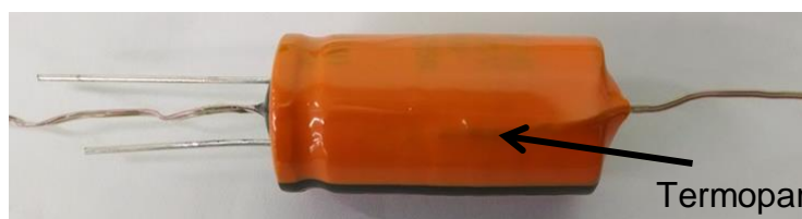
Figura 18 - Capacitor com segundo isolante para fixar o termopar na caneca
