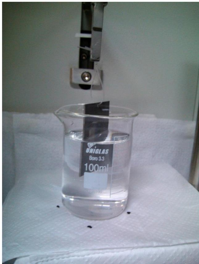
Figura 23 - Processo de imersão por dip-coating na solução sol-gel.
