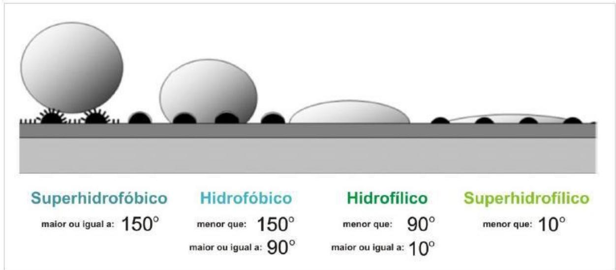
Figura 20 - Classificação das superfícies conforme a molhabilidade [61].
