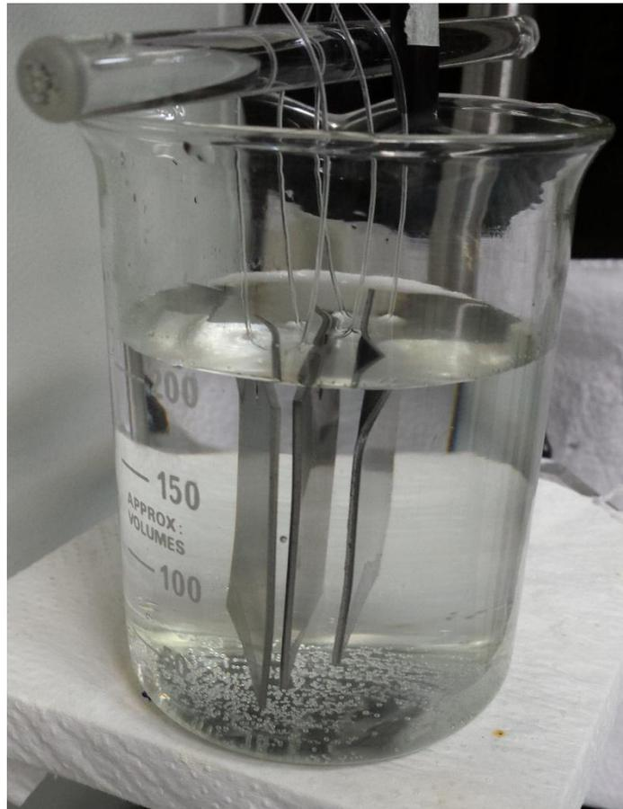
Figura 49 - Foto da imersão tripla dos substratos com superfície lisa em solução sol-gel com duas horas de hidrólise do silano VTES.
