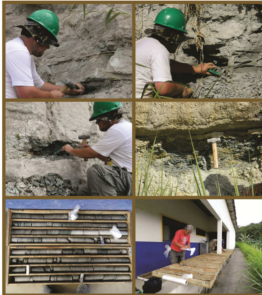
Figura 7: Coleta de amostras com posicionamento das mesmas nos perfis estratigráficos.
