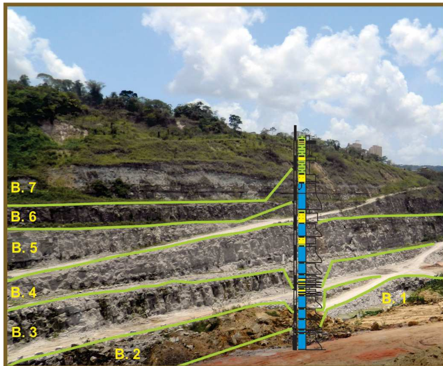
Figura 14: Levantamento do perfil composto devido a extensão lateral dos pacotes e facilidade de acompanhar a mesma litologia caminhando pelas bancadas.
