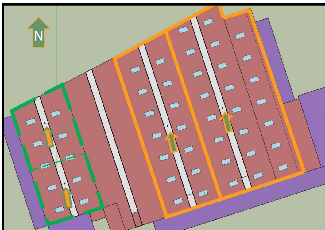
Figura 5–4 Vista superior do modelo termo energético com janelas zenitais e indicação dos luxímetros
