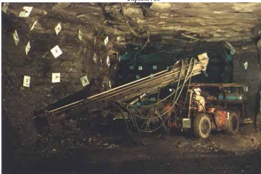
Figura 2 - Imagem ilustrativa da perfuratriz de frente, equipamento do conjunto mecanizado utilizado na fase de preparação da face, através da perfuração, para colocação de explosivos
