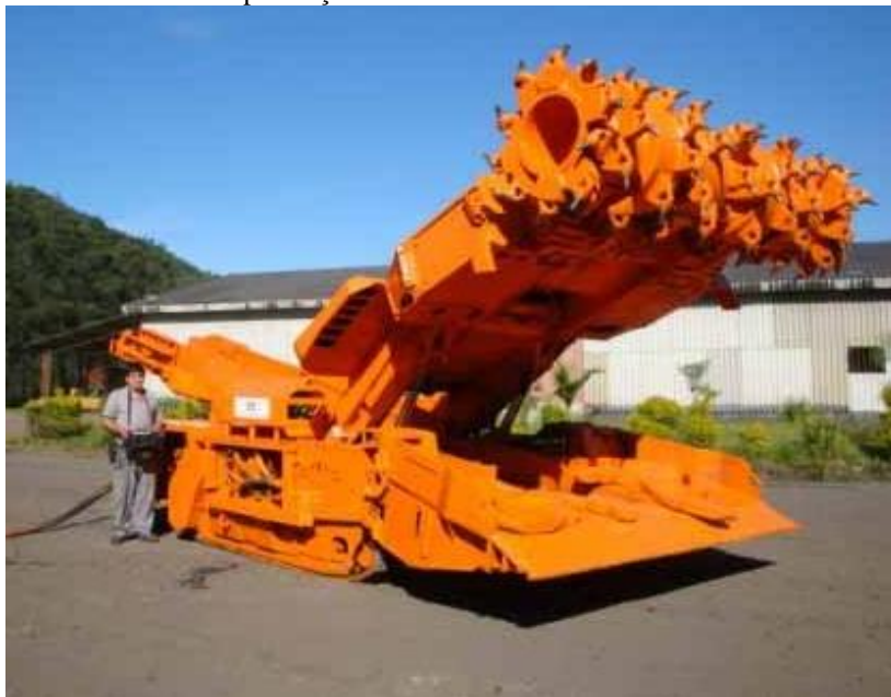
Figura 7 - Imagem do Minerador contínuo 12CM12, equipamento do conjunto mecanizado utilizado na fase de produção
