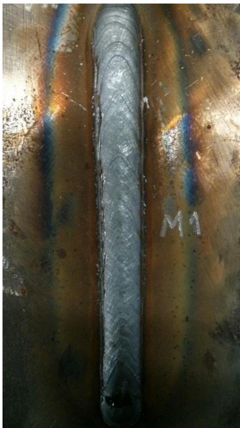
Figura 4.3 Experimento M1 mostrando uma trinca na região marginal direita do cordão de solda (referente à direção de soldagem, de baixo pra cima na imagem)
