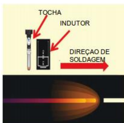
Figura 2.4 esquema da soldagem híbrida em tandem
