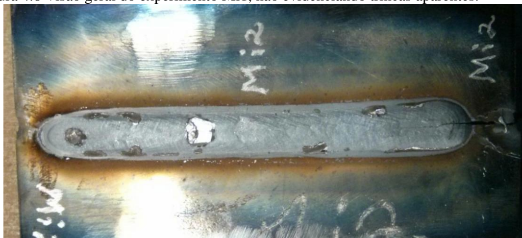
Figura 4.7 Visão geral do experimento Mi2 evidenciando trinca longitudinal no começo do cordão de solda.
