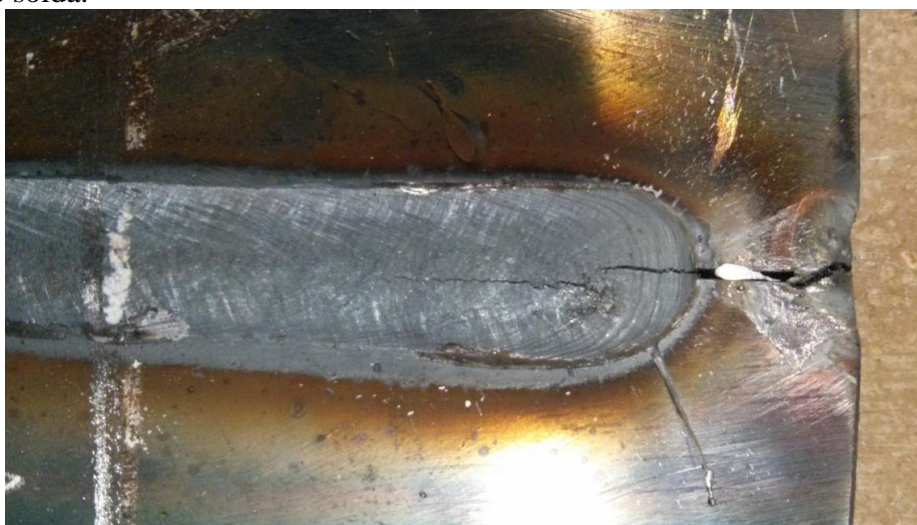
Figura 4.8 Região inicial do cordão do experimento Mi2i apresentando trinca longitudinal semelhante ao da Figura 4.7
