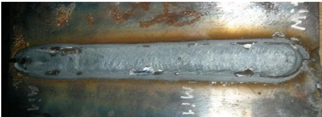
Figura 4.6 Visão geral do experimento Mi1, não evidenciando trincas aparentes.
