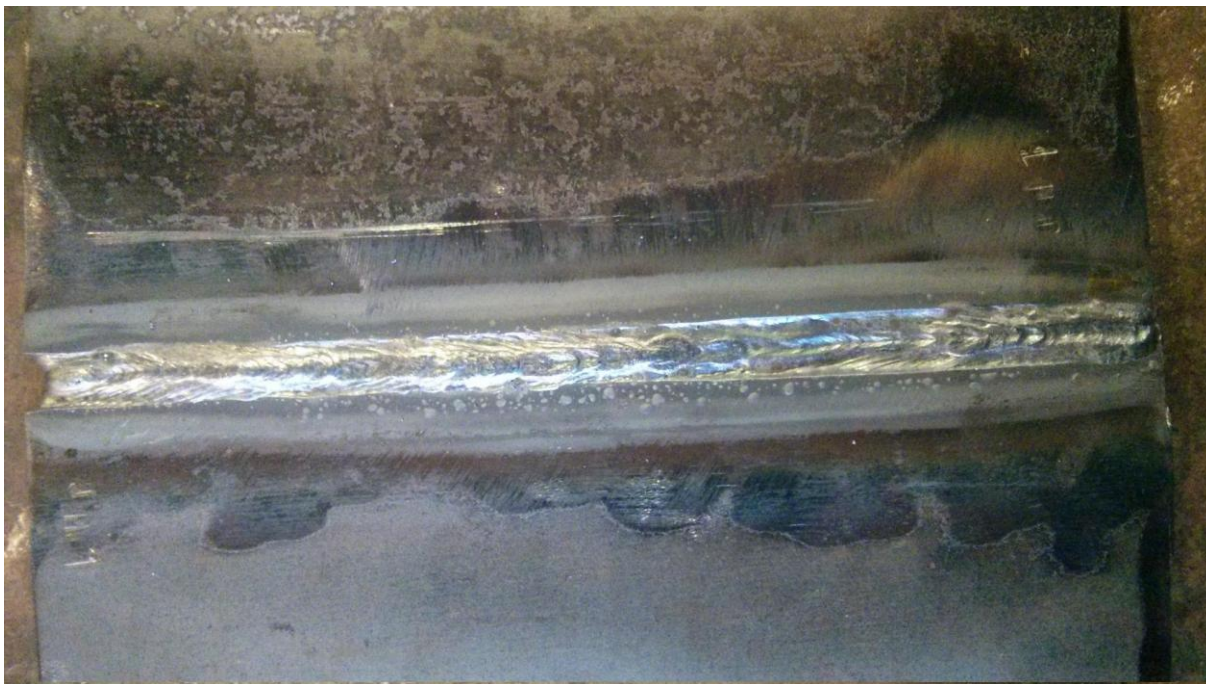
Figura 4.2 visão geral do cordão de solda do experimento JH1 mostrando início do fenômeno de humping .
