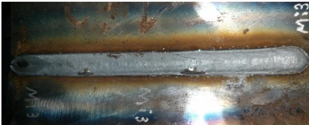
Figura 4.9 Visão geral do experimento Mi3, não apresentando nenhuma trinca aparente.
