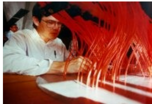
Figura 4.4 - Encaixe das fibras ópticas nos orifícios da placa de alumínio.
