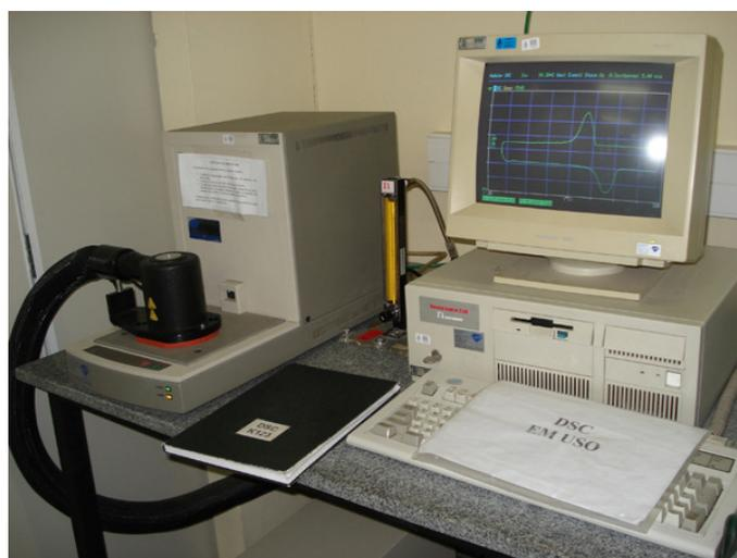
**Figura 3.** Equipamento Thermal Analysis Instruments DSC-2010.
