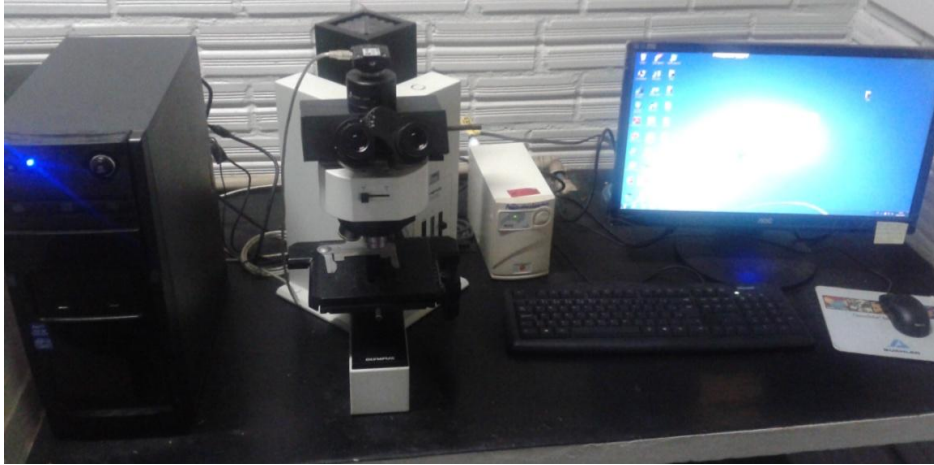
Figura 3.2 – Microscópio ótico com a câmera matricial conectado ao computador via cabo USB.
