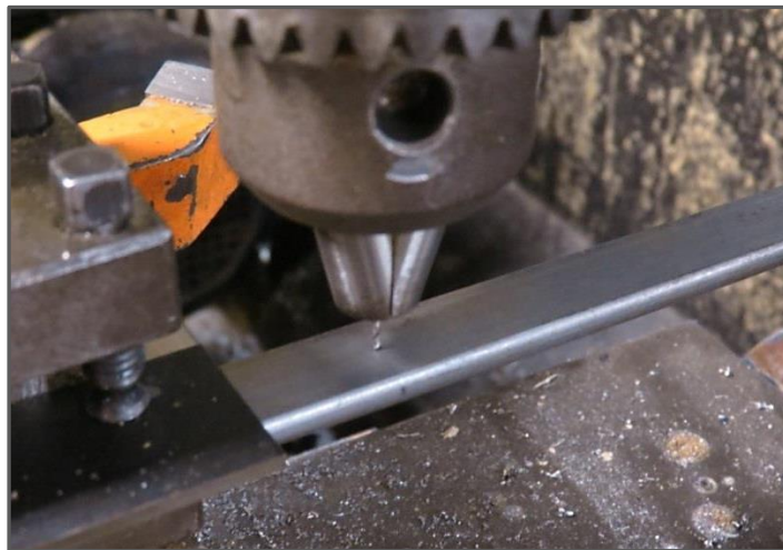
Figura 4.8. Inserção de defeito em corpo de prova com uma broca de aço.
