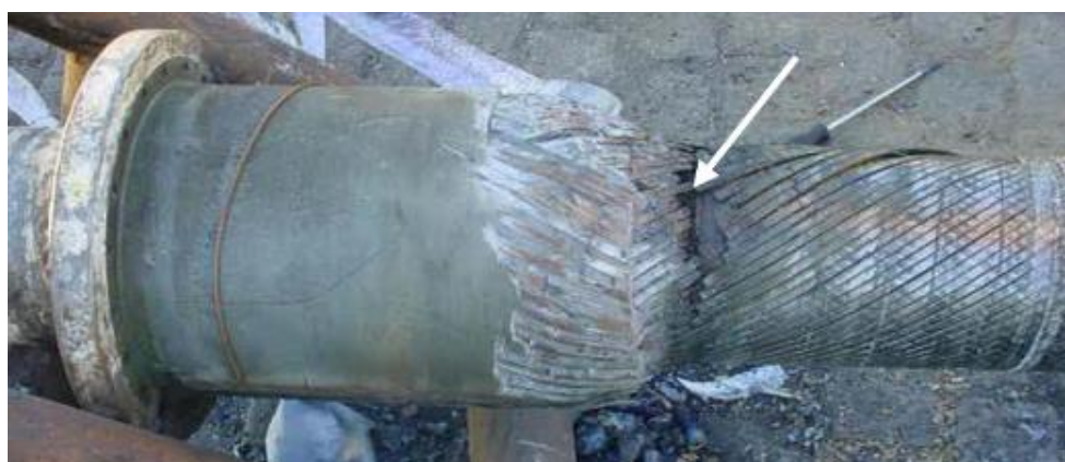
Figura 3.4. Terminal conector com arames da armadura de tração rompidos. Fonte: MARINHO (2008).
