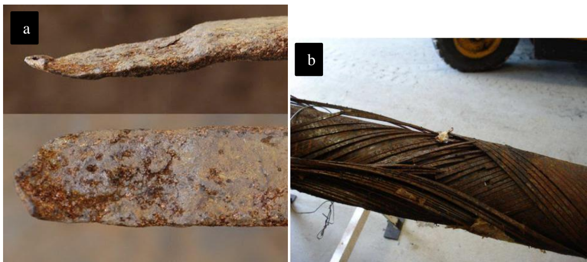
Figura 3.6. a) Defeitos geométricos oriundos do processo de corrosão em um arame de tração rompido (4SUBSEA, 2013); b) corrosão generalizada. (BUENO, 2010)
