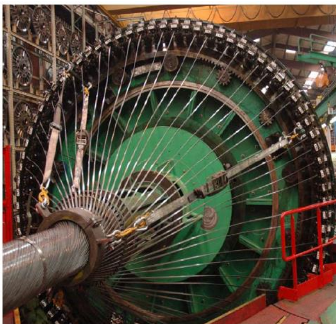
Figura 3.2. Processo industrial de construção da armadura de tração de um duto flexível. Fonte: 4SUBSEA (2013)
