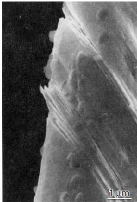
Figura 3.19. Intrusões e extrusões de uma folha de cobre observados em MEV. Fonte: MEYERS AND CHAWLA (2008).
