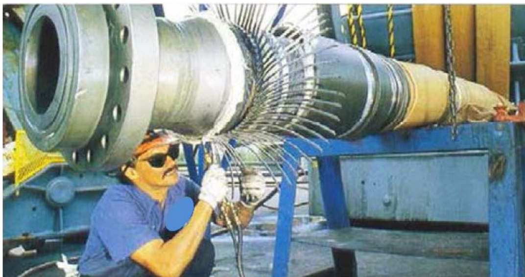
Figura 8.2. Dobramento dos arames da armadura de tração durante o processo de montagem do conector. Fonte: CAMPELLO (2014)
