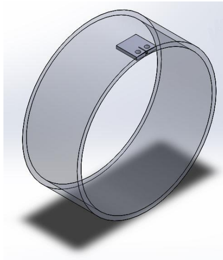
Figura 3.3 Orientação do corpo de prova em relação ao tubo.
