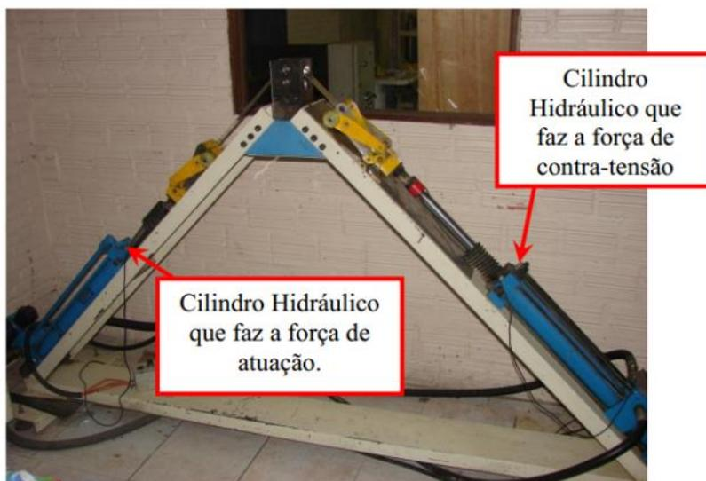
Figura 3.5 Máquina de avaliação de atrito através de ensaio DST. Fonte: Adaptado de Folle, 2012.
