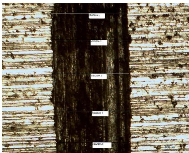
Figura 3.4 Representação das medidas realizadas na trilha desgastada.
