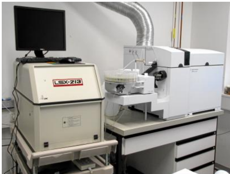
Figura 13: LA-ICP-MS ( Inductively Coupled Mass Spectrometer ) modelo Agilent 7700, da Universidade de Stuttgart, Alemanha.
