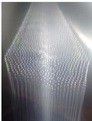
FIGURA 18 - FORMAÇÃO DE FIAÇÃO NO CABEÇOTE B COM UTILIZAÇÃO DE 5% DE RECICLADO T3
