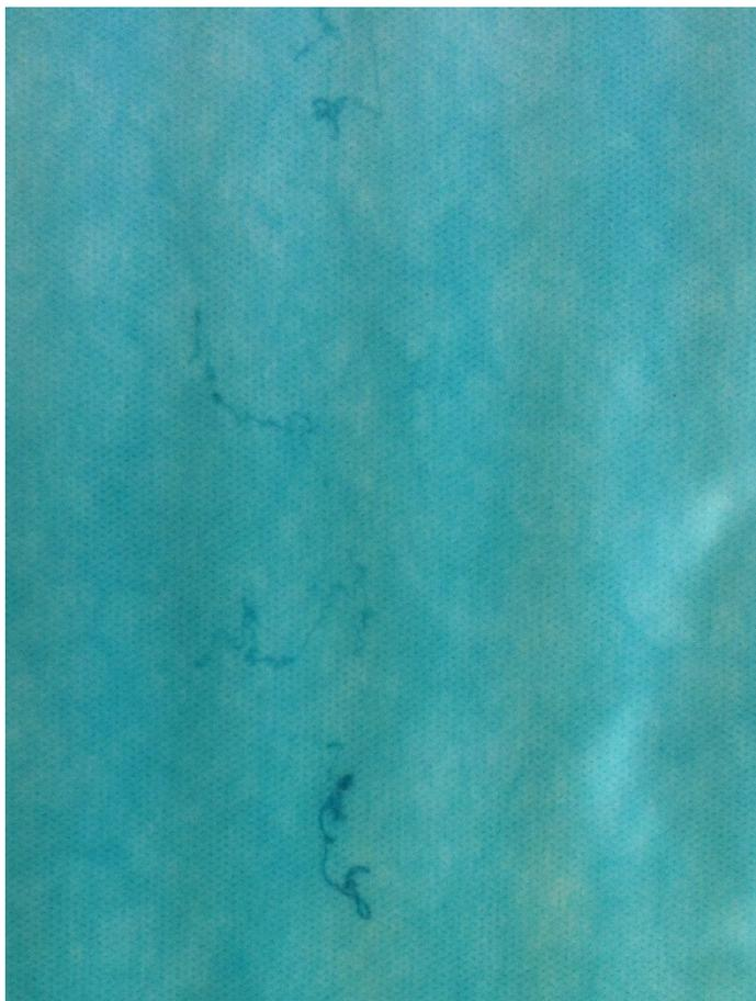
FIGURA 24 - DEFEITO DE PLASTIFICAÇÃO EM NÃOTECIDO SSMMS VERDE UTILIZADO NA PRODUÇÃO DE DESCARTÁVEIS HIGIÊNICOS
