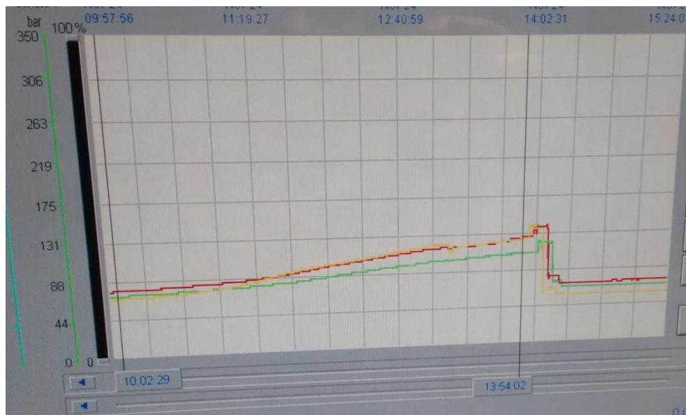
FIGURA 27 - VERIFICAÇÃO DE PRESSÃO DE TELAS FILTRO X TEMPO EM PRODUÇÃO PADRÃO (PELLET PADRÃO A 8% NOS 3 CABEÇOTES DA EXTRUSORA)
