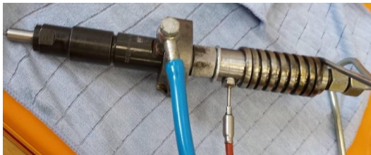
Figura 4.2 – CA com termopar, resistor e CPI acoplados.
