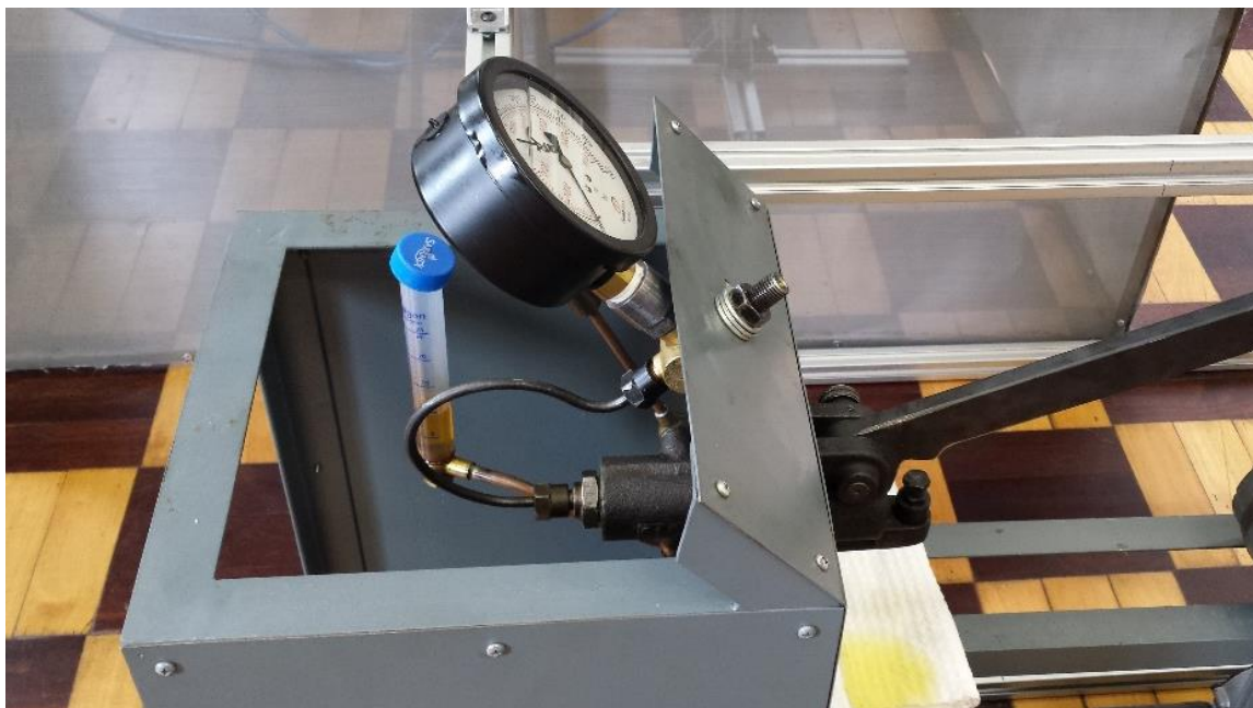
Figura Al.1 – Bomba hidráulica com alavanca de acionamento, manômetro e reservatório de combustível
