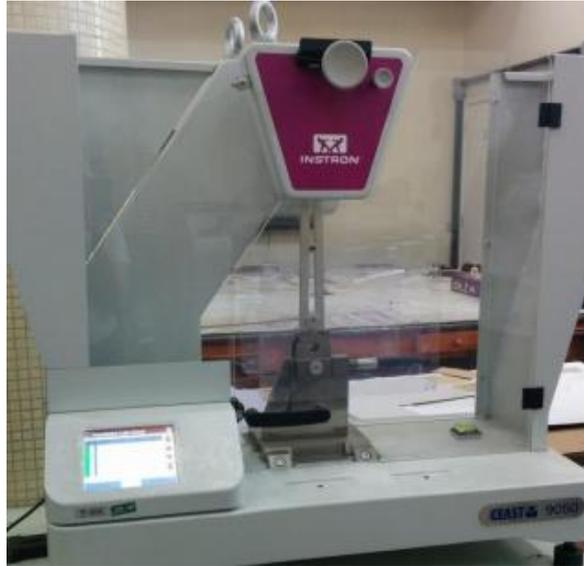
Figura 22. Equipamento de ensaio de impacto.
