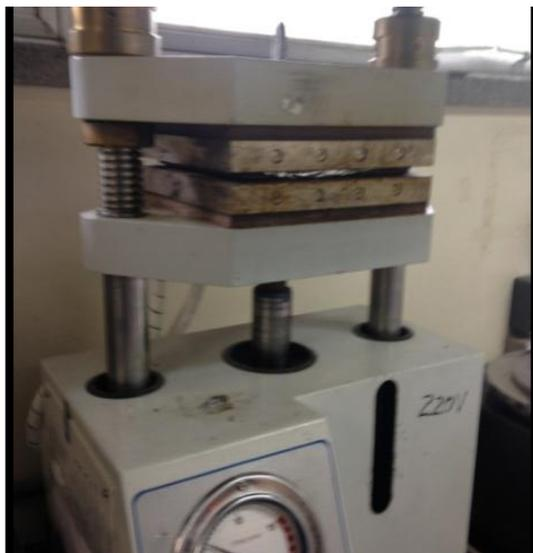
Figura 20. Prensa hidráulica com aquecimento, marca Solab, modelo SL11
