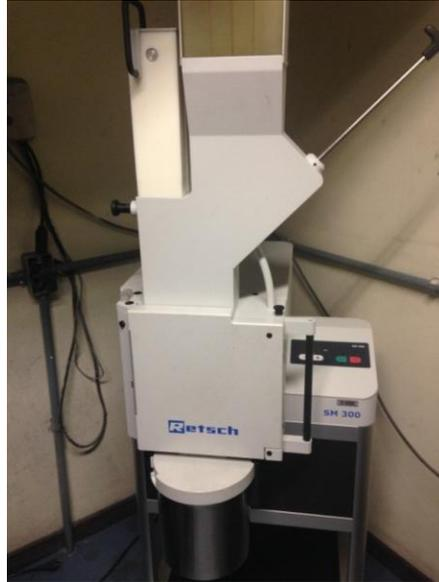
Figura 19. Moinho de facas utilizado para a trituração
