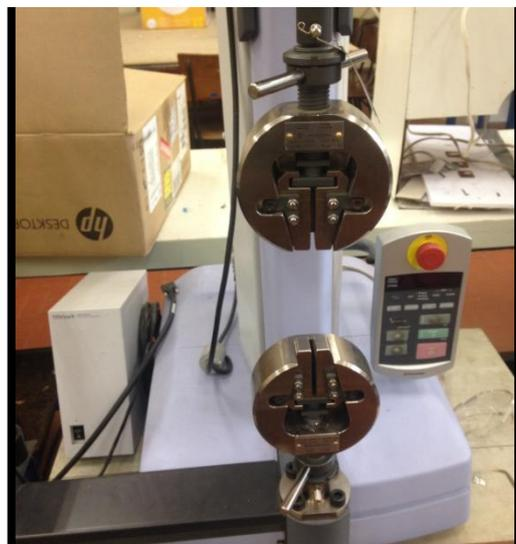
Figura 23. Equipamento de ensaios universal EZ-LX da marca Shimadzu.
