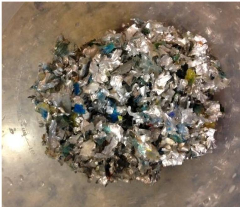
Figura 18. Material aglutinado de alumínio/polietileno após hidrapulper e liquidificador.
