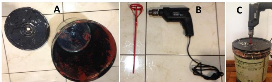
Figura 16. Componentes do hidrapulper adaptado: A - Balde de 18 litros. B - Furadeira e haste. C - Sistema montado.
