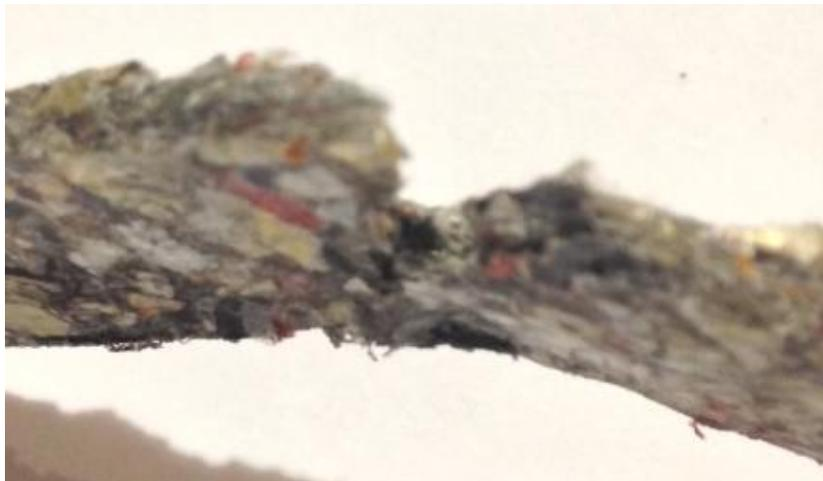
Figura 34. Área de rompimento parcial do corpo de prova EmbCafé.
