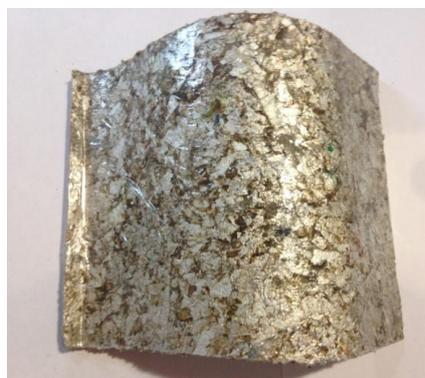
Figura 26. Telha comercial de embalagens cartonadas recicladas.
