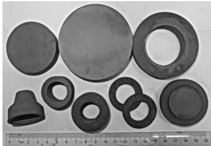
**Figura 3:** Componentes cerâmicos de  $ZrB_2$ -SiC produzidos por gel casting.
