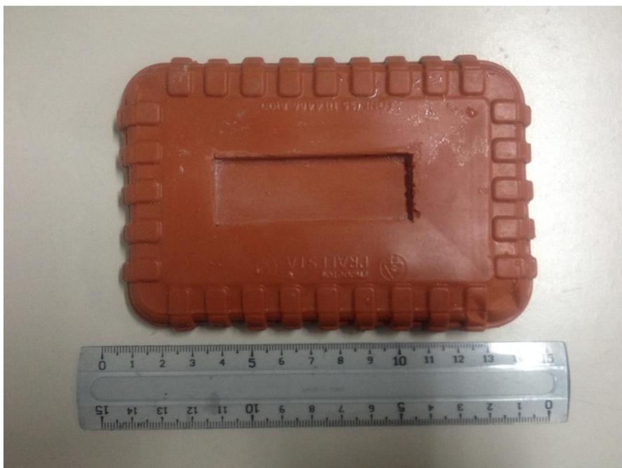
**Figura 10:** Molde de silicone utilizado para confecção dos corpos de prova estudados.
