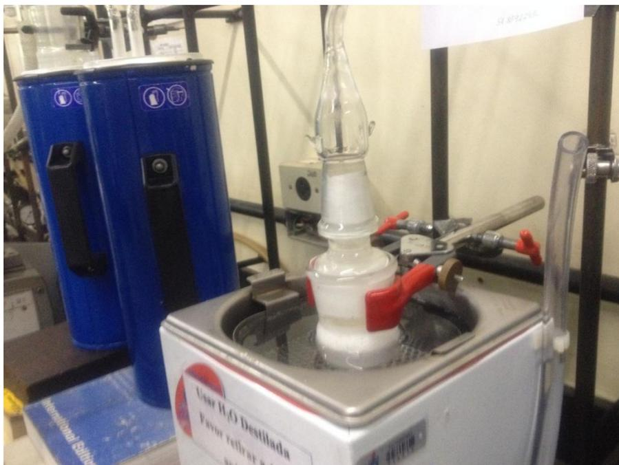
**Figura 22:** Montagem do sistema a vácuo com auxílio de um ultrassom.
