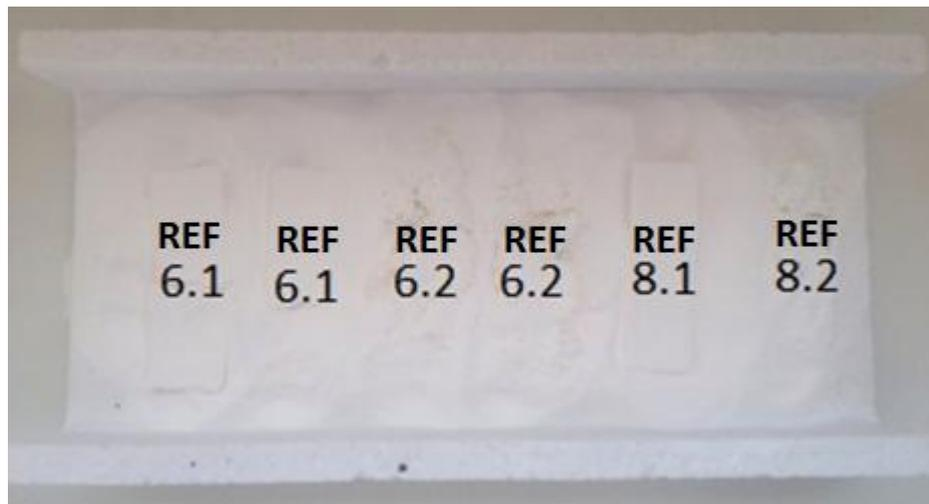
**Figura 20:** Peças pré-sinterizadas obtidas com corpos à verde produzidos usando o processo refinado.
