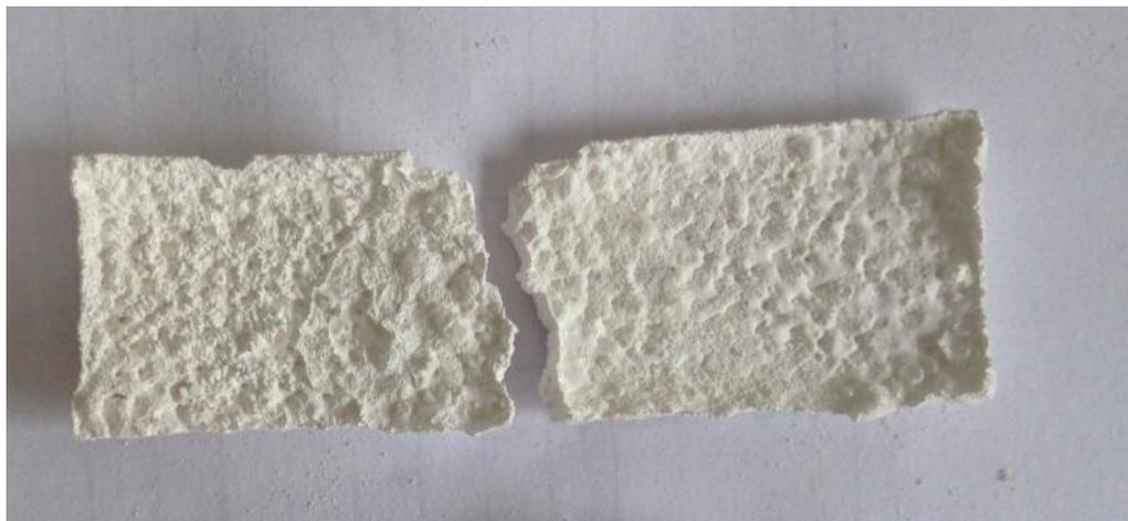
**Figura 17:** Amostra pré-sinterizada (código SS4) – trincada.
