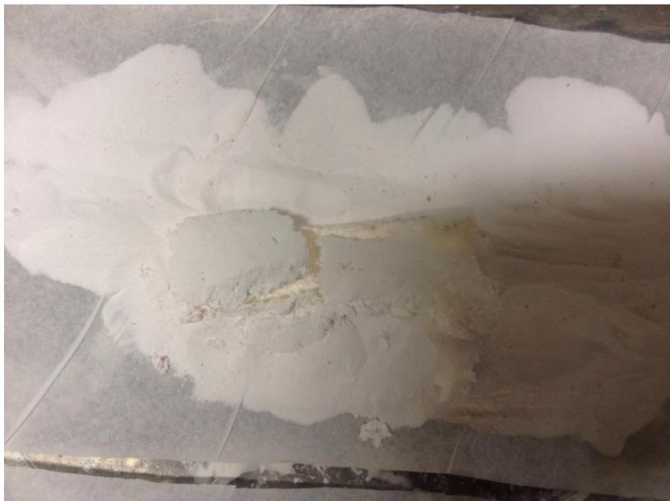
**Figura 15:** Corpo pré-sinterizado (código SS2) – amostra colapsada.
