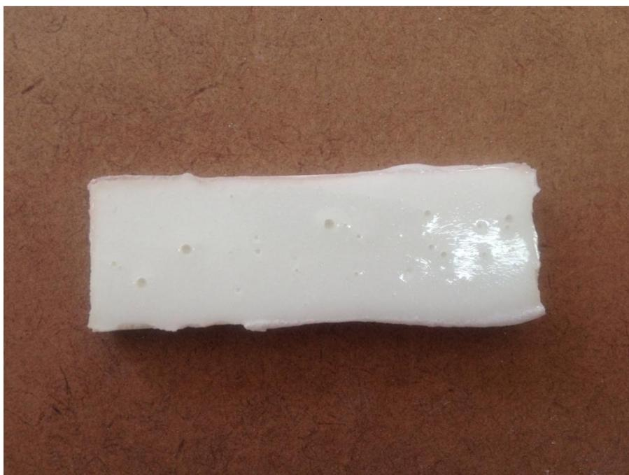
**Figura 14:** Corpo à verde (código SS2) utilizando somente a resina 1 e o endurecedor.
