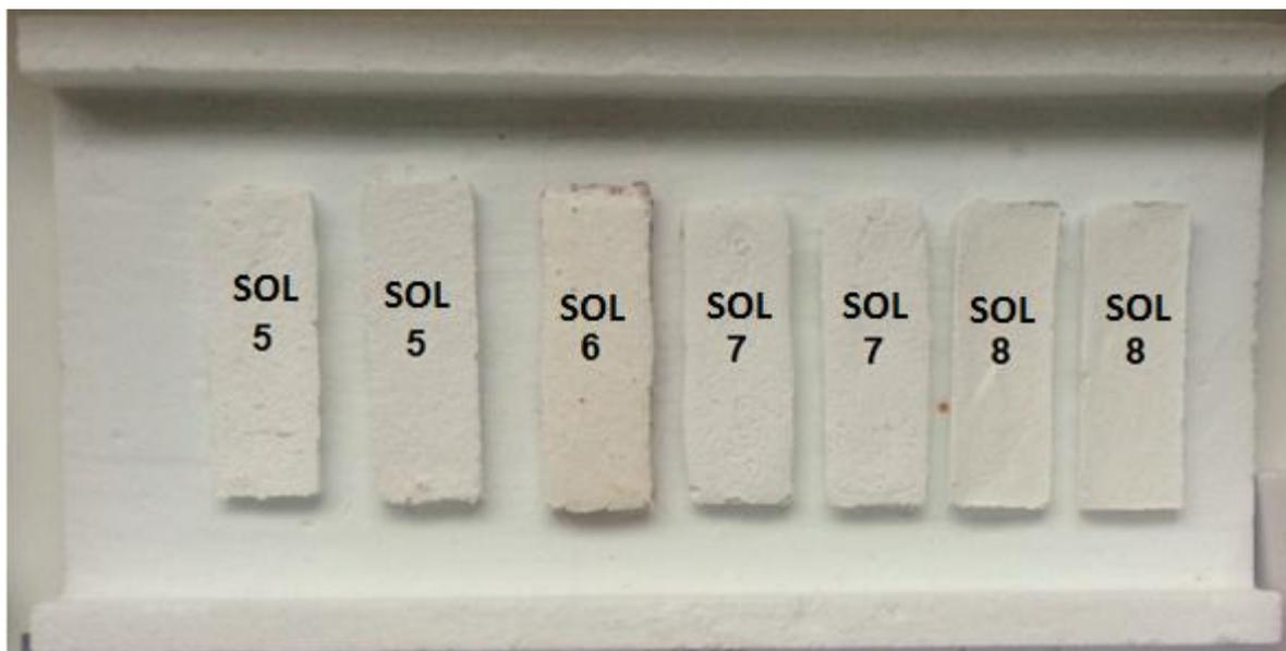
**Figura 18:** Corpos à verde de códigos SOL5 a SOL8 utilizando as duas resinas e o solvente.
