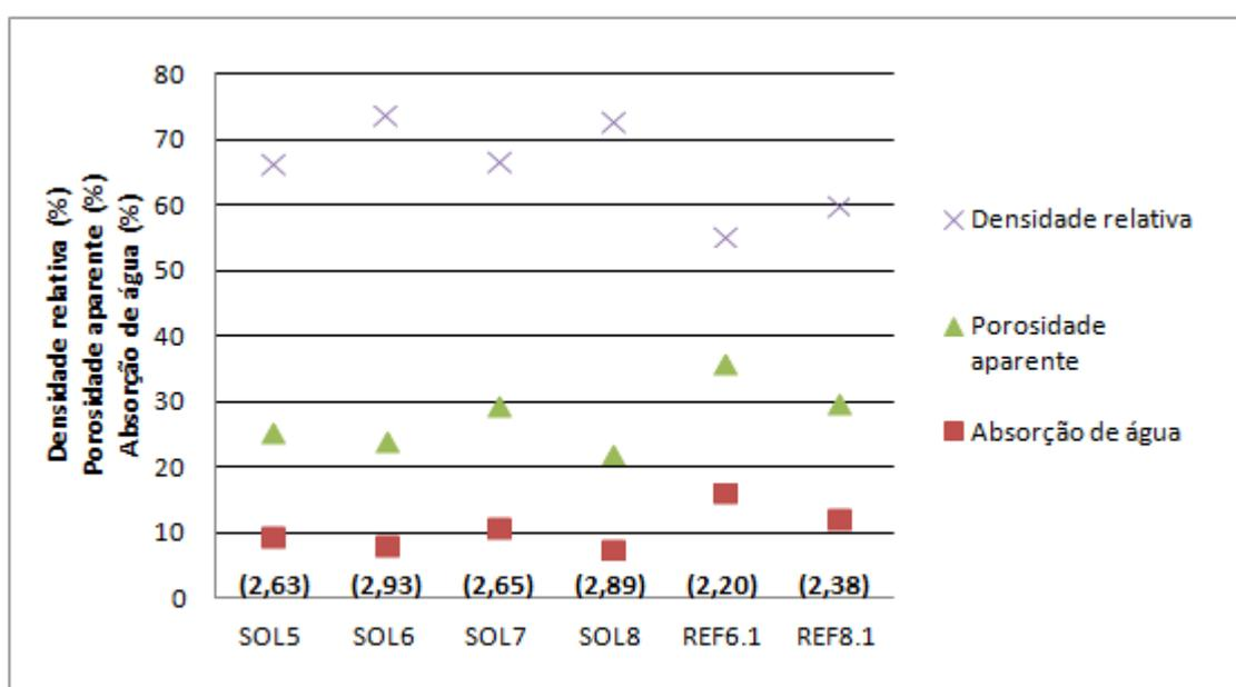
**Figura 21:** Densidade relativa, porosidade aparente, absorção de água e entre parênteses a massa específica aparente dos corpos de prova sinterizados.
