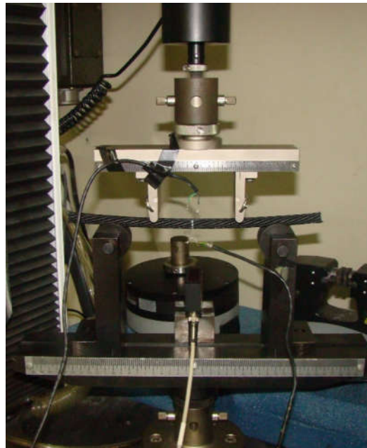
Figura 18 – Ensaio de flexão em quatro pontos no cabo CFRP.
