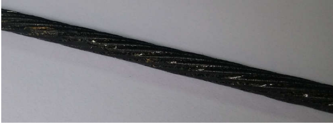
Figura 22 - Amostra do cabo 1×10 mostrando excesso de resina oriundo de sua fabricação.
