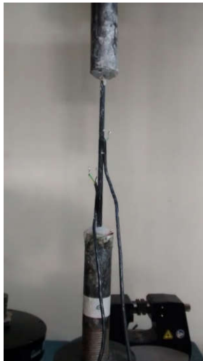
Figura 17 - Ensaio de tração em cabo 1×10 instrumentado com dois SGs.
