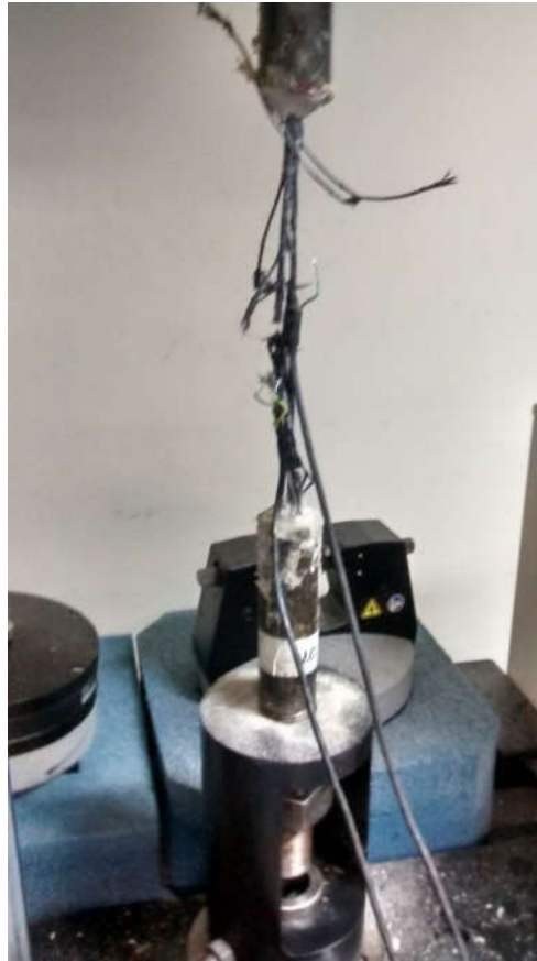
Figura 38 - Ruptura do cabo 1×10 em tração.
