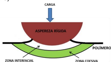
Figura 3.3 – Duas classes gerais de mecanismos de desgaste [Adaptado: Briscoe, 1981].
