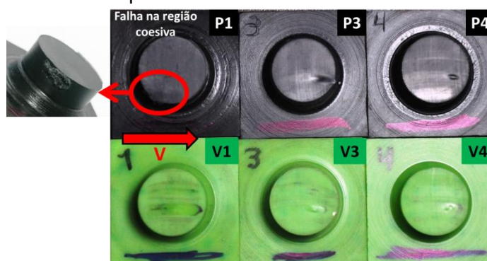
Figura 5.4 – Corpos de prova dos plásticos de engenharia estudados após terem alcançado o limite PV do material. A seta “V” indica a direção de deslizamento do disco.
