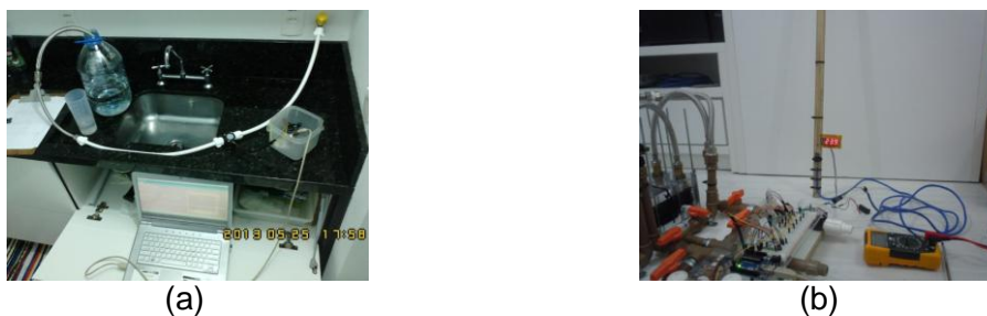
Figura 1 – (a) calibração da vazão, (b) calibração de pressão.
