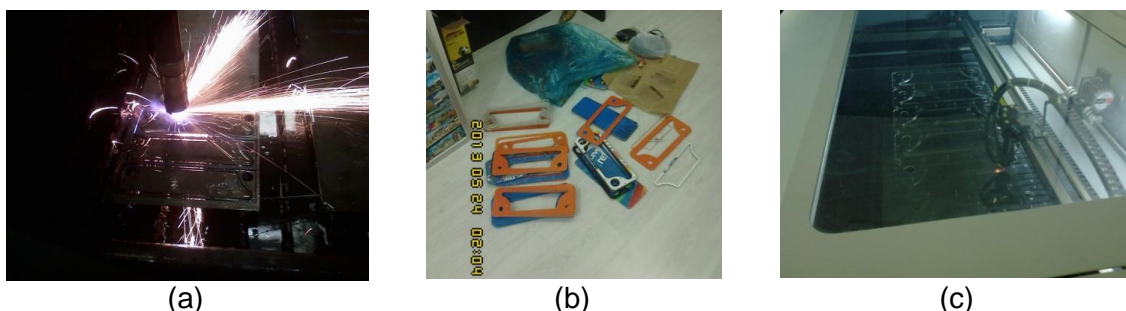
Figura 2- (a) chapas de aço SAE1020 de P1 cortadas a plasma, (b) lâminas do P2 feito de PET reciclado após usinagem, (c) placas de P3 cortados a laser em PET e acrílico cristal.
