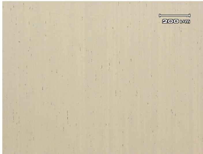
Figura 4.3 – Microestrutura AISI 316L mostra a presença de ferrita delta. Ácido oxálico 10% mais água. 1000X.
