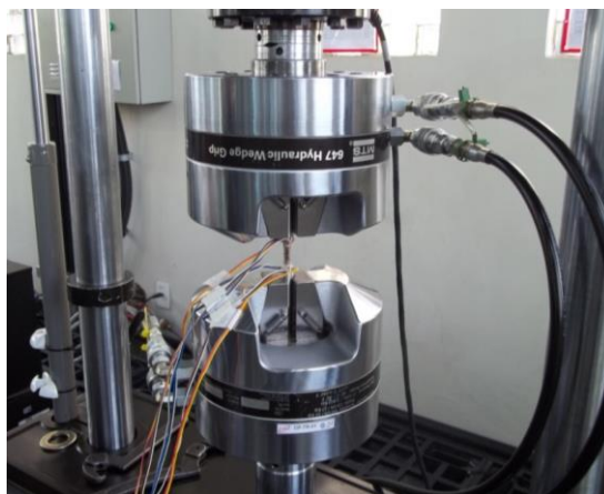
Figura 3.10 – Sistema de leitura da deformação realizada pelos strain gauges .
