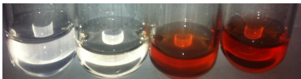
Figura 5.19. Acima: fotografias de resíduos líquidos de DEF de quatro processos eletroforéticos com as argilas p e c com eletrodos de aço e de grafite. Abaixo: análises qualitativas de presença de íons de ferro, na mesma ordem.
