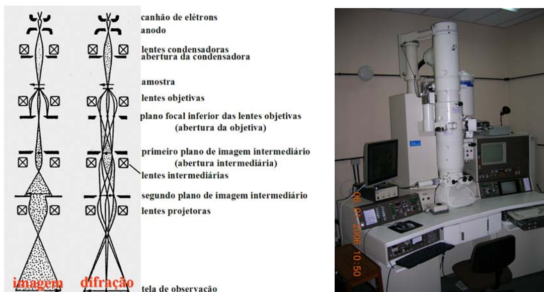
Figura 3.11. Esquema do interior da coluna do Microscópio Eletrônico de Transmissão e a foto do MET 200 kV do Centro de Microscopia Eletrônica da UFRGS.
