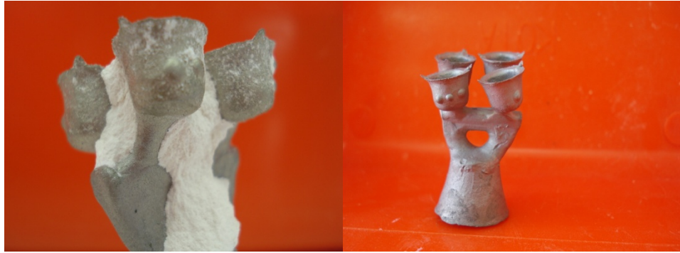
Figura 6 e 7. Fundição e usinagem das coroas metálicas.
