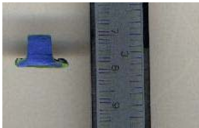
Figura 9. Secção transversal da silicona para medição, com o paquímetro milimetrado para conversão em micrometros e escaneamento.
