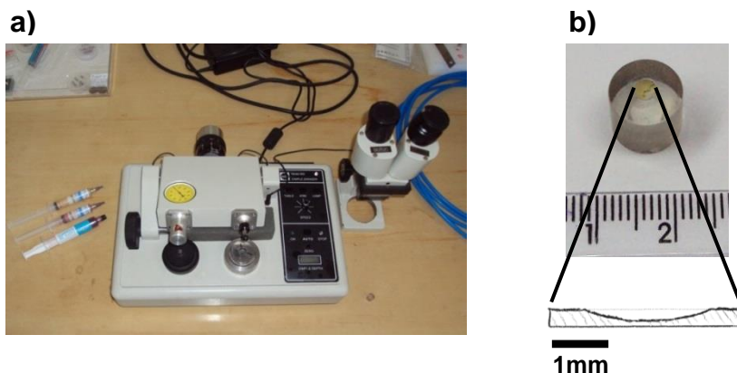
Figura 12: a) Dimpler utilizado para o afinamento da região central da amostra; b) Perfil da amostra depois do desbaste com o dimpler .
