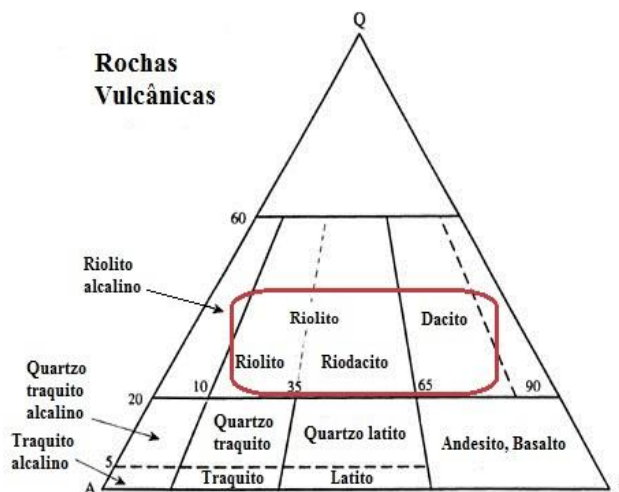
Figura 4: Diagrama ternário com o teor dos principais minerais das rochas hospedeiras da opala do RS. A: álcalis (feldspatos alcalinos). P: plagioclásio Q: quartzo. Modificado de Le Maitre et al. (2002)
