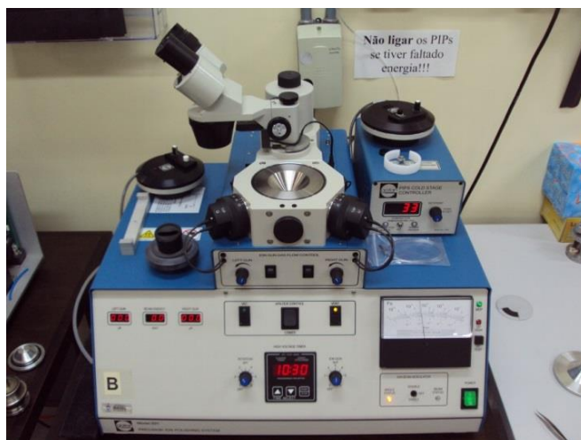
Figura 14: a) Ion Mill para acabamento final da amostra; b) Perfil da amostra depois do desbastamento com íons de argônio. A região transparente a elétrons está indicada com setas.
