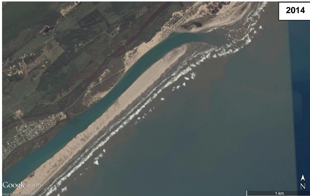
Figura 28: Rio Araranguá em 27/03/2014 (fase 5). Avanço da colmatação e diminuição significativa do meandro abandonado. Fonte: Google Earth Pro.
