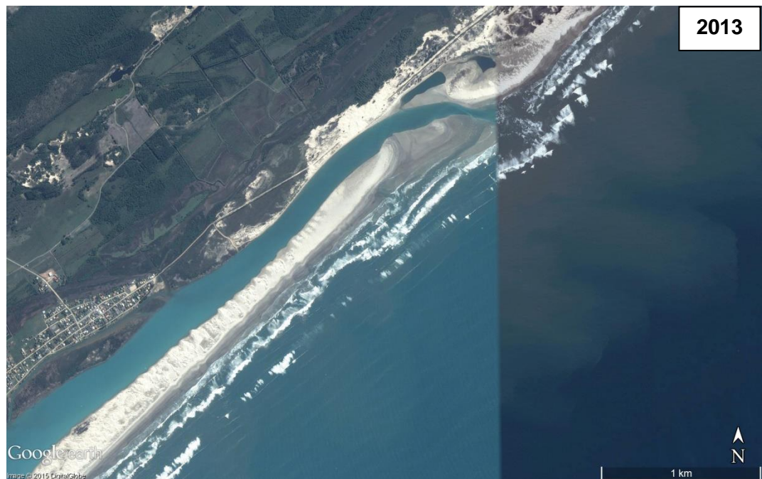
Figura 27: Rio Araranguá em 27/04/2013 (fase 4). Diminuição deste corpo d'água devido a continuidade da colmatação (até mesmo depois do confinamento). Este preenchimento do meandro abandonado é realizado pelos leques de sobrelavagem e sedimentos provenientes do sistema eólico. Fonte: Google Earth Pro.
