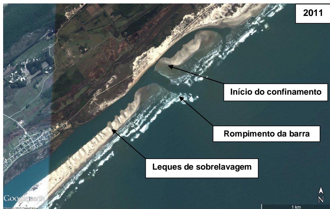
Figura 25: Rio Araranguá em 01/06/2011 (fase 2). Rompimento da barra causada pela erosão das ondas, gerando uma nova desembocadura. É possível observar também leques de sobrelavagem na porção sul da barra. Início do confinamento. Fonte: Google Earth Pro.
