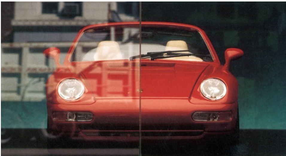
Fig. 11: A esquerda um vidro comum e a direita o vidro Amiran. [49]
