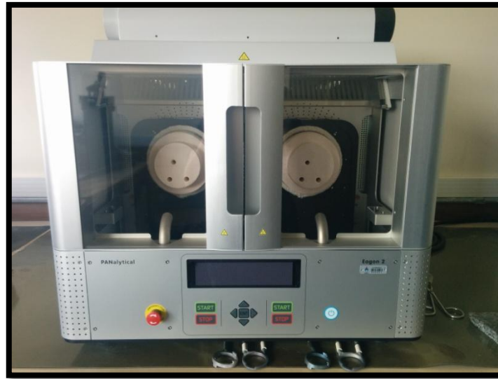
Figura 18: Equipamento para preparação de amostras fundidas da marca PANalytical, modelo Eagon 2, disponível no Laboratório de Geoquímica do CPGq.
