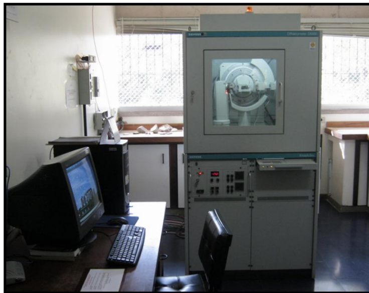
Figura 14: Difratômetro SIEMENS, modelo D5000 com goniômetro \theta - \theta disponível no Laboratório de Difractometria de Raios X do CPGq.
