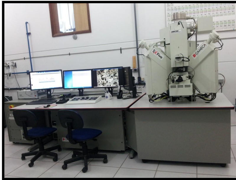
Figura 15: Microsonda eletrônica modelo Cameca SX Five disponível no Laboratório de Microsonda Eletrônica do CPGq no Instituto de Geociências.
