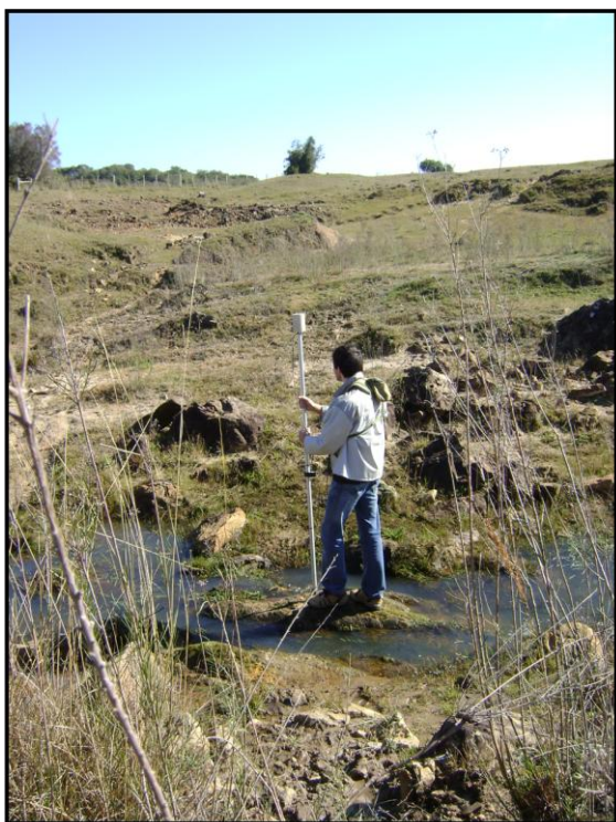
Figura 5: Levantamento magnetométrico sendo feito usando os mesmos pontos.
