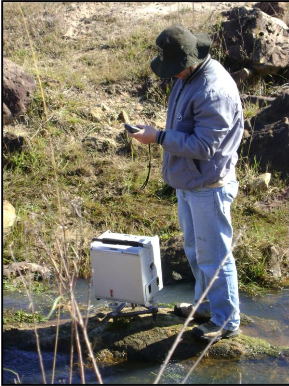
Figura 4: Gravímetro usado em campo coletando dados sobre a rocha em estudo.
