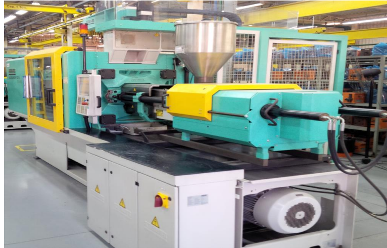
Figura 32 - Injetora Arbor com sistema de injeção à vácuo
