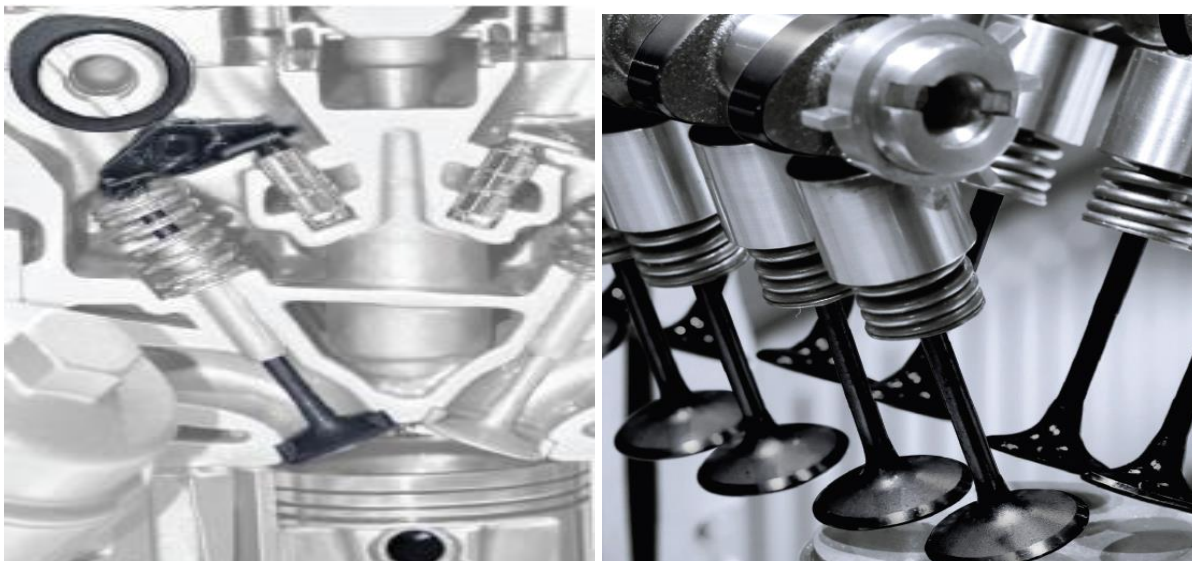
Figura 21 - Corpos de válvulas oxinitrocarbonetados (QPQ) em corpos de válvulas de motores
