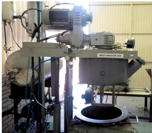
Figura 31 - Misturador para a obtenção da massa metal-polímero
