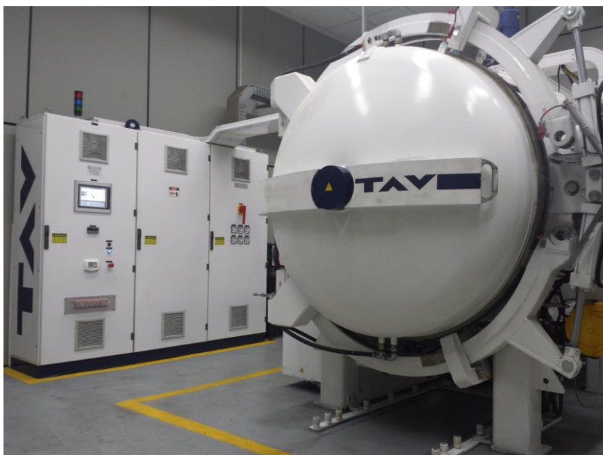
Figura 34 - Forno à vácuo marca TAV – H6, utilizado para a solubilização dos aços 316 L e 17 4 PH
