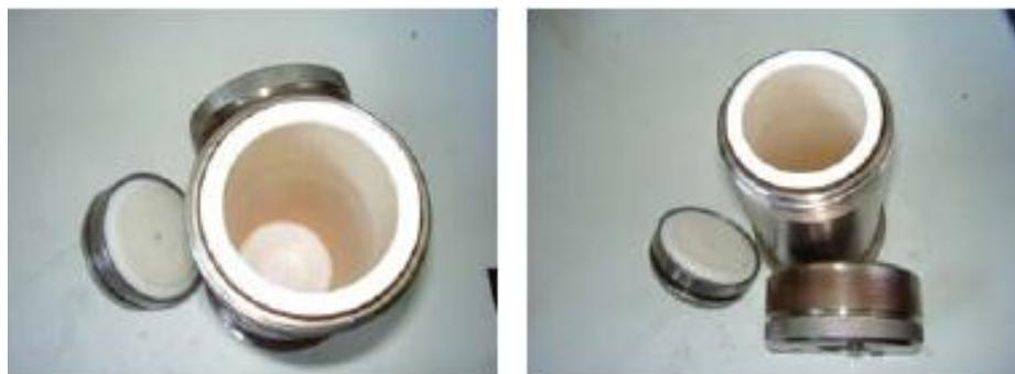
**Figura 2.5:** Autoclave utilizada nos ensaios de perda de massa no estudo de Gonçalves (2007).
