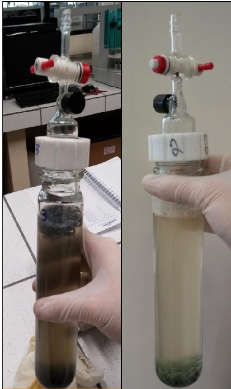
Figura 3.3: Biorreator logo após montagem (esquerda) e biorreator após dias de biodegradação(direita).
