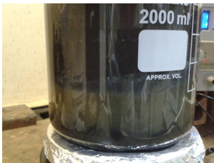
Figura 5.13 - Detalhe do aspecto físico do efluente ao final do experimento de eletrocoagulação realizado com concentração de NaCl = 4 g/L, quantidade de eletrodos = 2 e distância entre eletrodos = 10 mm e densidade de corrente = 188 mA/cm 2 .
