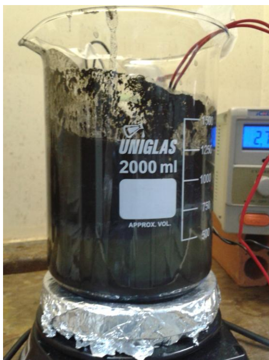
Figura 5.12 - Aspecto físico ao final do experimento de eletrocoagulação realizado com concentração de NaCl = 4 g/L, quantidade de eletrodos = 2 e distância entre eletrodos = 10 mm e densidade de corrente = 188 mA/cm 2 .
