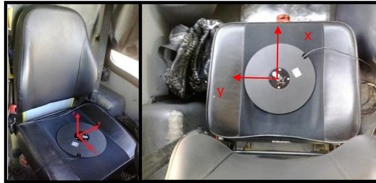
Figura 3.2 - Seatpad posicionado corretamente no assento para procedimento de medição
