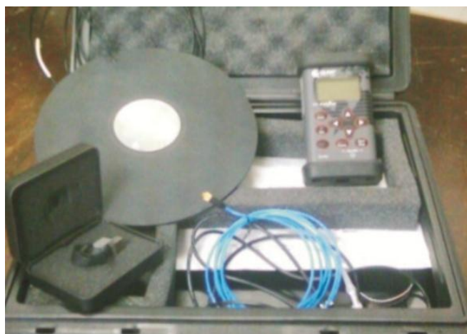
Figura 3.1 - Medidor VI400-Pro e seatpad usados nas medições
