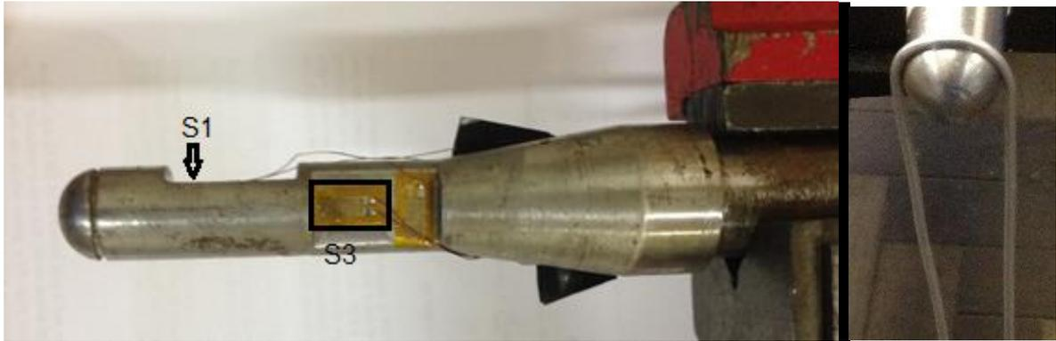
Figura 25 - Ferramenta presa a morsa de bancada para calibração de extensômetros.
