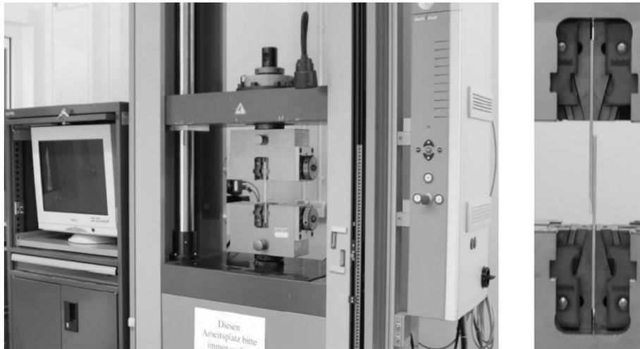
**Figura 4.4** Máquina Zwick/Roell e detalhe do sistema de fixação do corpo de prova.
