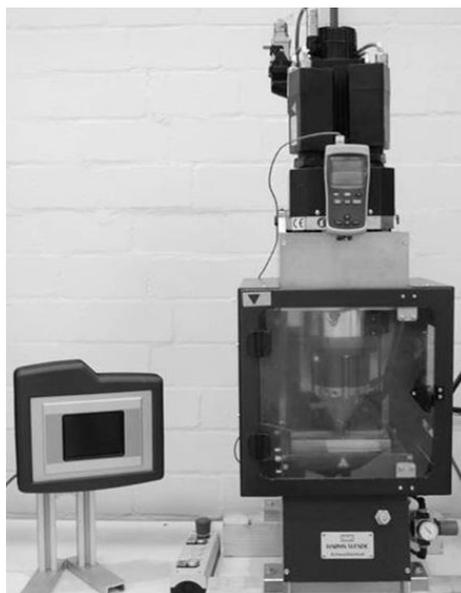
**Figura 4.3** Máquina de soldagem *FSpW* RSP 100 acoplado ao sistema de monitoramento.
