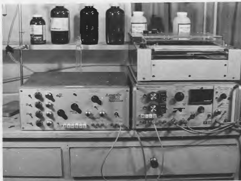
Fig. 22 - Fotografia dos equipamentos utilizados nas curvas de polarização.
